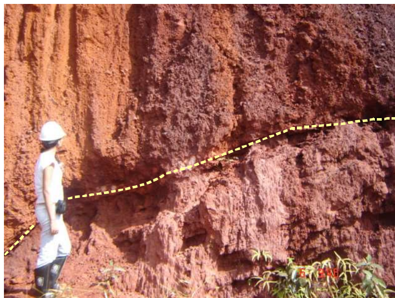
Figura 6: Contato entre o latossolo (parte superior) e a crosta laterítica.
