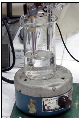
Figura 9.1: Conjunto contendo agitador magnético, eletrodo combinado de prata, Becker de vidro e bureta graduada
