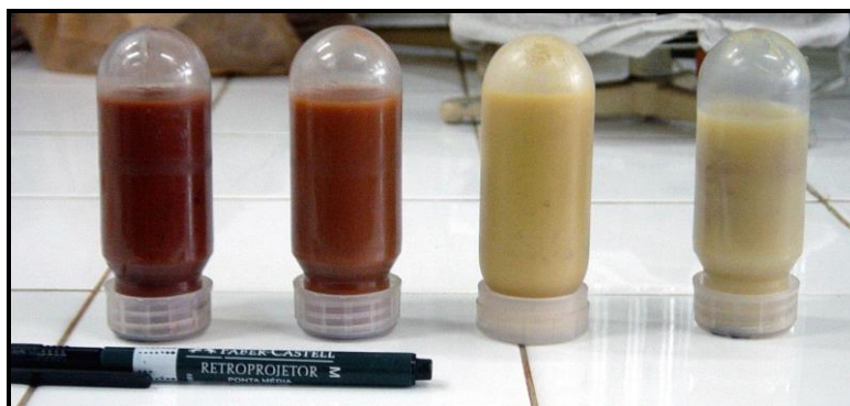
Figura 7.5: Ilustração da diferença (na coloração) das amostras durante o processo de retirada de ferro.
