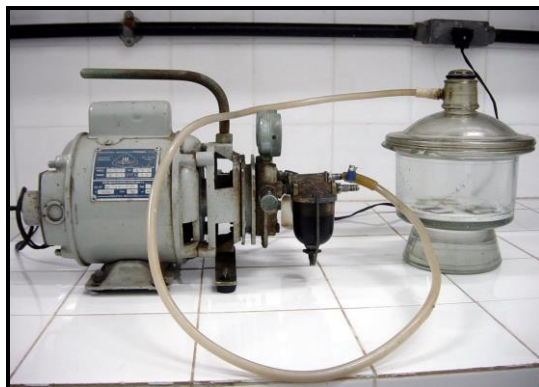
Figura 7.3: Conjunto contendo uma bomba a vácuo e um dessecador com fundo preenchido por etilenoglicol
