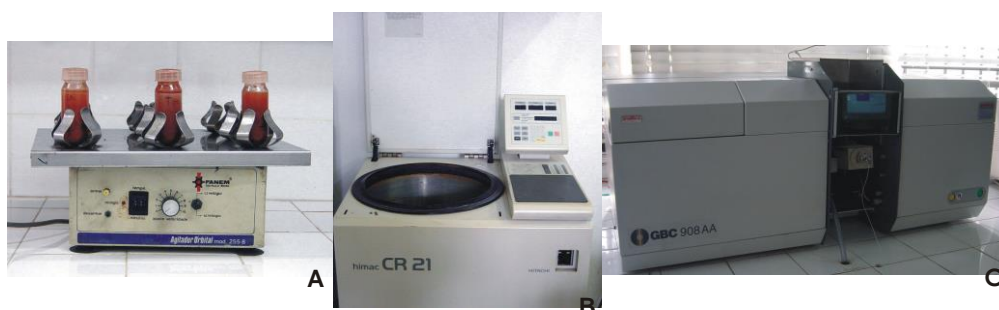
Figura 8.2: Montagem feita com os aparelhos responsáveis pelo sistema de agitação (8.2A), sistema de Centrifugação (8.2B) e pela leitura da concentração do potássio (8.2C).
