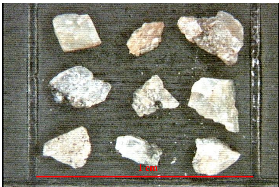
Figura 82: Grãos da amostra Gnaiss facoidal 2 retidos na peneira #16.
