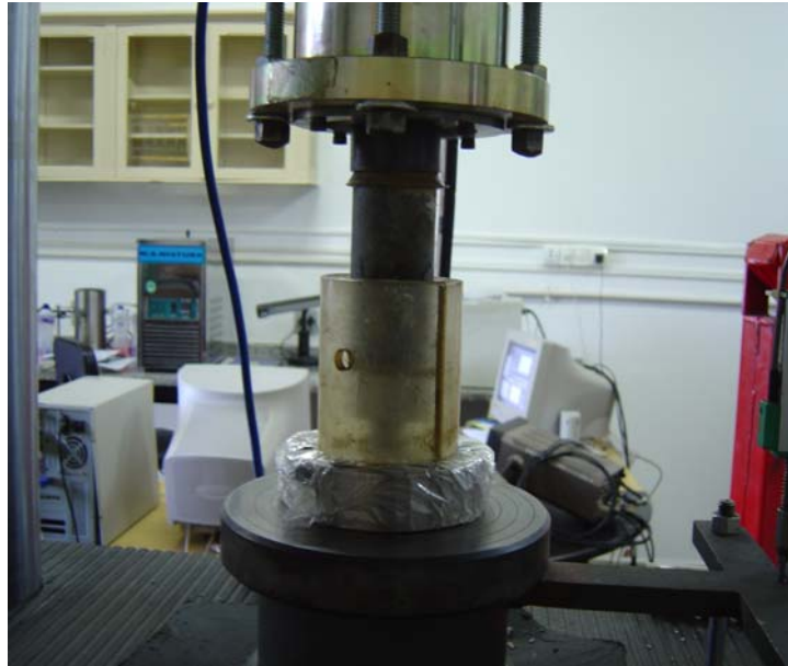
Figura 46: Corpo de prova na prensa hidráulica para o rompimento.
