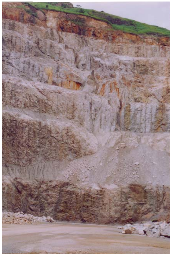
Figura 36: Detalhe do esquema de bancadas na pedreira do Nefelina-sienito.
