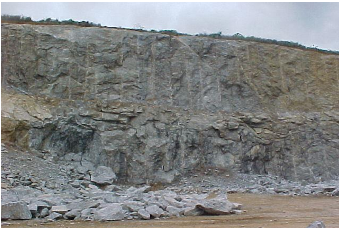
Figura 30: Detalhe do fraturamento irregular nas bancadas da pedreira do Granada-gnaïsse.
