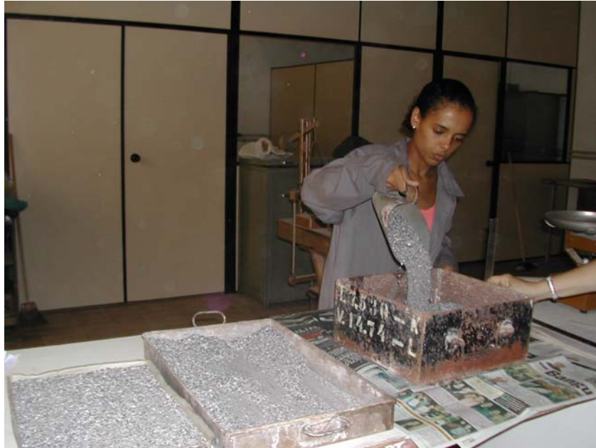
Figura 39: Colocação do agregado seco, em estado solto, dentro do recipiente para determinação da massa unitária: notar altura de despejo.
