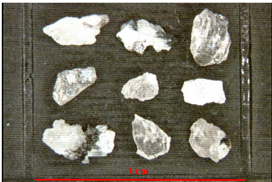
Figura 86: Grãos da amostra Granito-gnaiss retidos na peneira #16.
