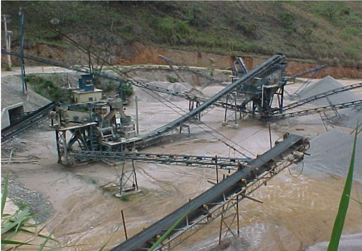
Figura 31: Sistema de britagem e separação dos materiais da pedra do Granada-gnaisse.
