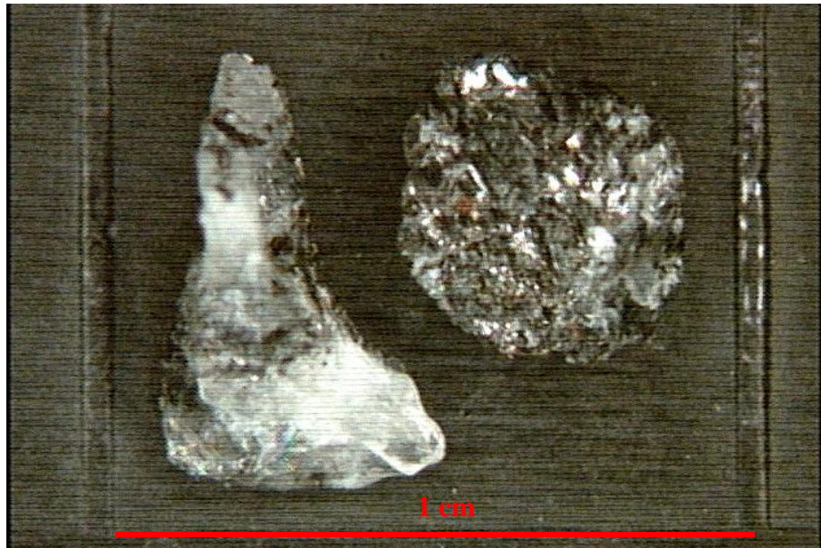
Figura 79: Grãos da amostra Gnaiss facoidal 1 retidos na peneira #8.
