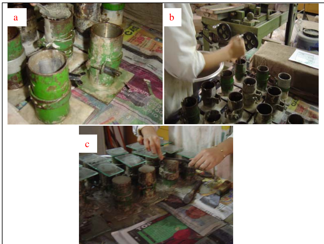
Figura 44: a) Moldes cilíndricos parafinados e untados; b) Golpes na argamassa colocada dentro dos moldes para melhor preenchimento; c) Moldes já cheios de argamassa sendo cobertos por placa de vidro.
