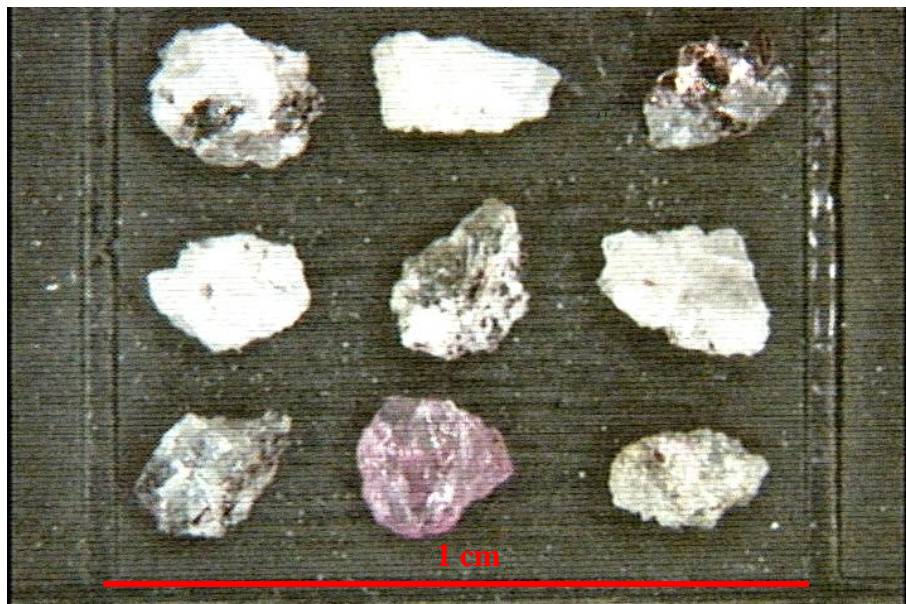
Figura 84: Grãos da amostra Granada-gnaisse retidos na peneira #16.
