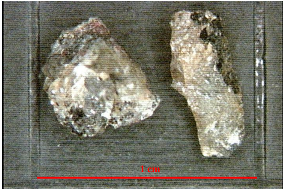
Figura 81: Grãos da amostra Gnaiss facoidal 2 retidos na peneira #16.
