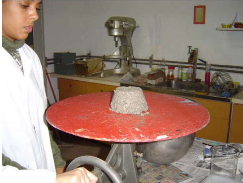
Figura 42: Aplicação dos golpes para a determinação do cálculo da trabalhabilidade.
