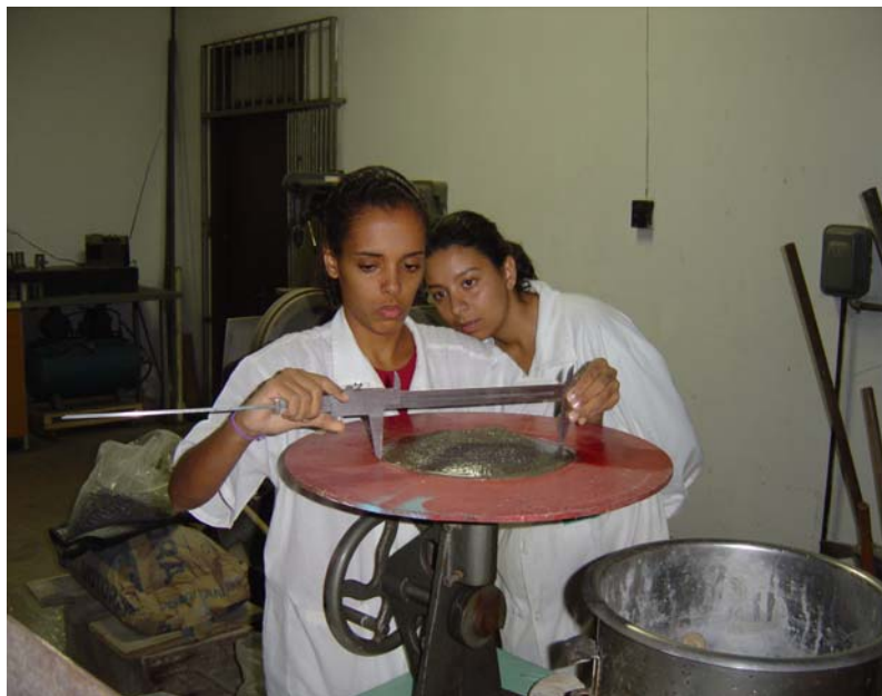
Figura 43: Medida da abertura da massa em milímetros para o cálculo da trabalhabilidade.
