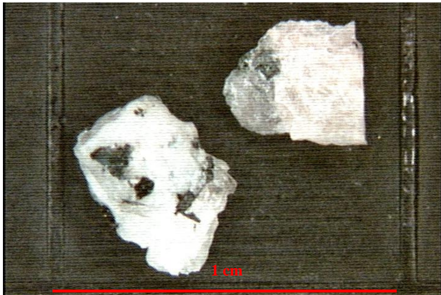
Figura 85: Grãos da amostra Granito-gnaiss retidos na peneira #8.
