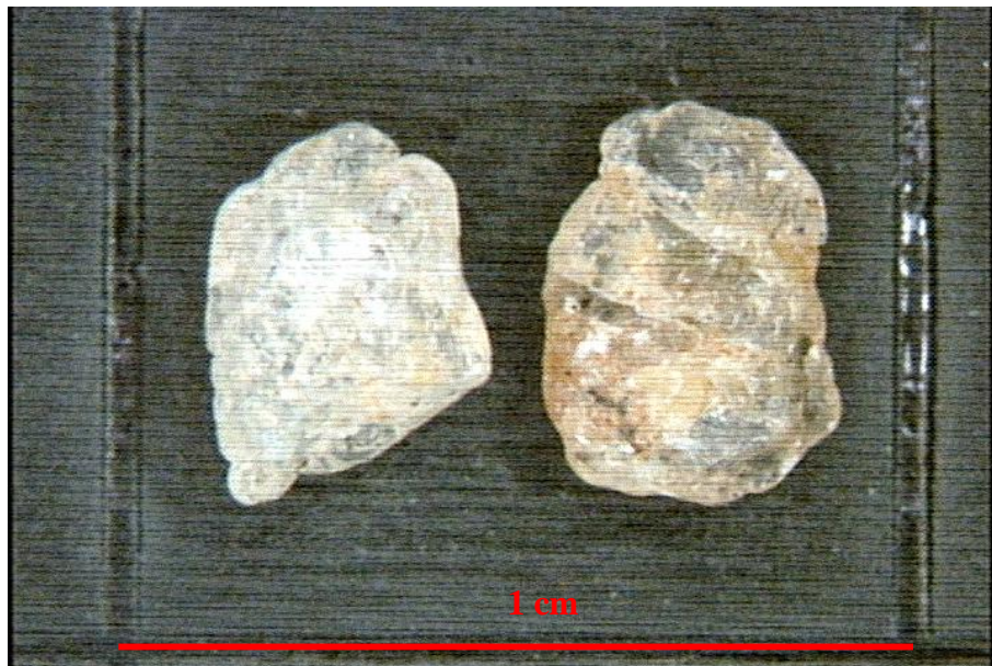
Figura 73: Grãos da amostra Areal 1 retidos na peneira #8.
