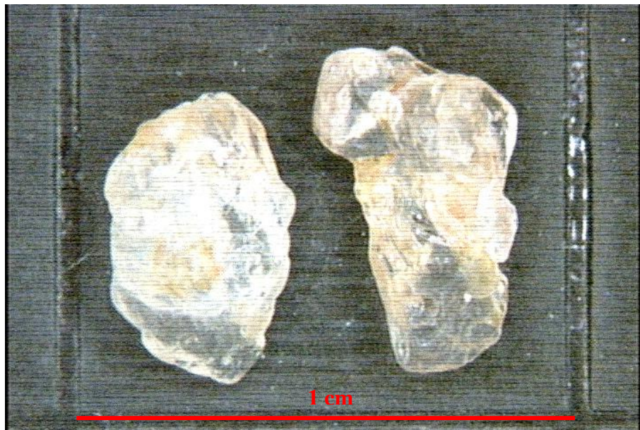
Figura 75: Grãos da amostra Areal 2 retidos na peneira #8.
