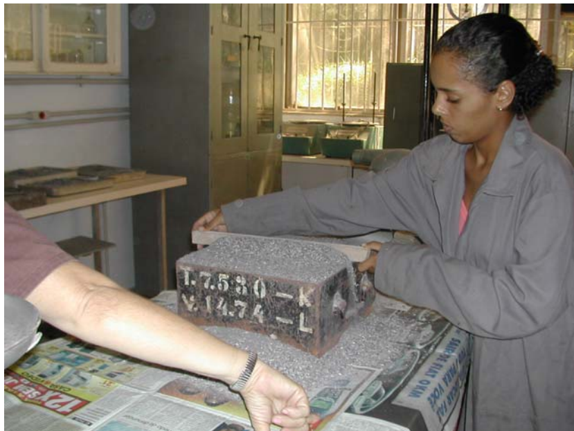
Figura 40: Retirada do excesso de material sobre o recipiente para determinação da massa unitária.
