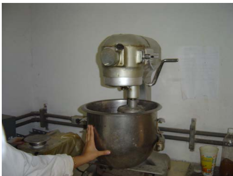
Figura 41: Preparo da mistura para a determinação da trabalhabilidade.
