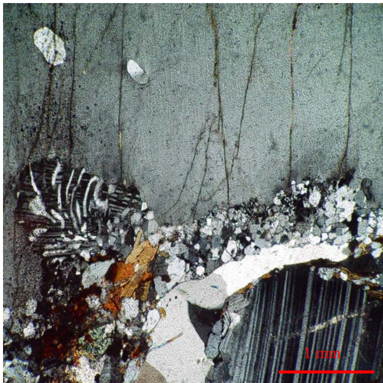
Figura 63: Textura mirmerquítica e grão de feldspato com microfissuras preenchidas por óxido de ferro.
