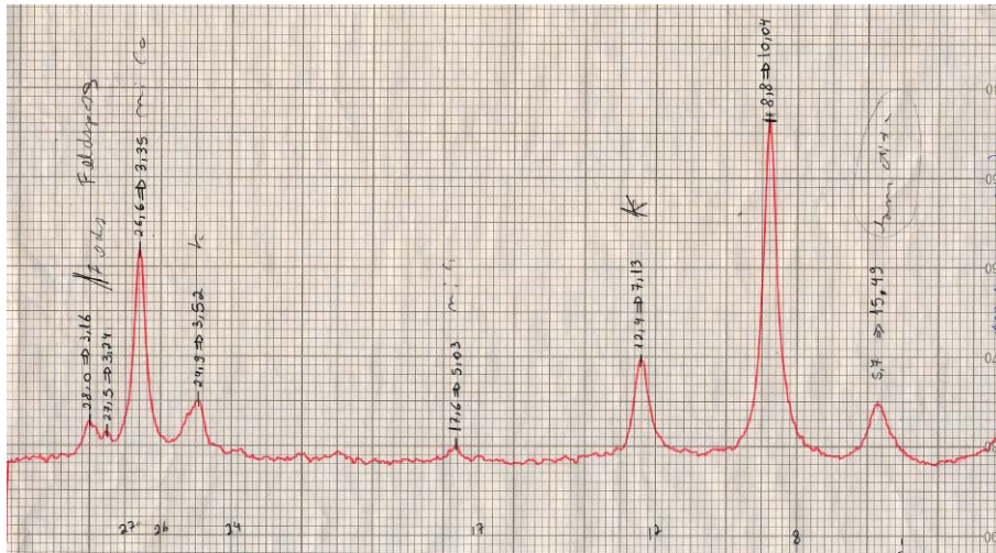
Figura 103: Difratoograma da lâmina de argila, do tipo normal, da amostra Gnaiss facoidal 1.
