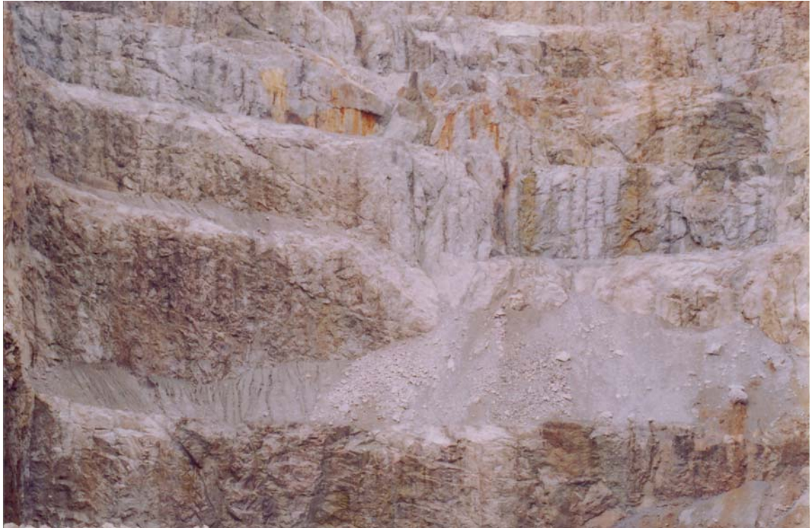
Figura 37: Detalhe do fraturamento do maciço na pedreira do Nefelina-sienito.
