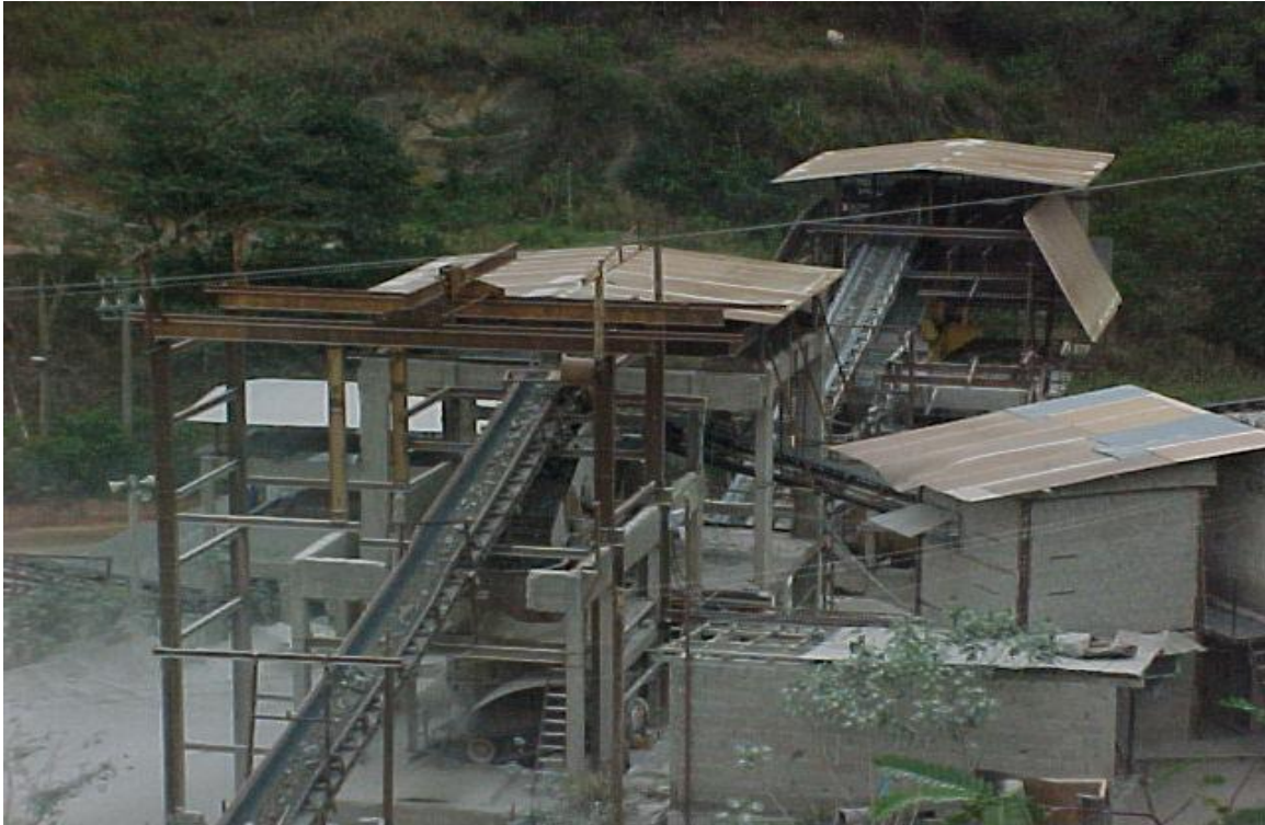
Figura 15: Sistema de britagem e separação dos materiais na pedreira do Charnoquito.
