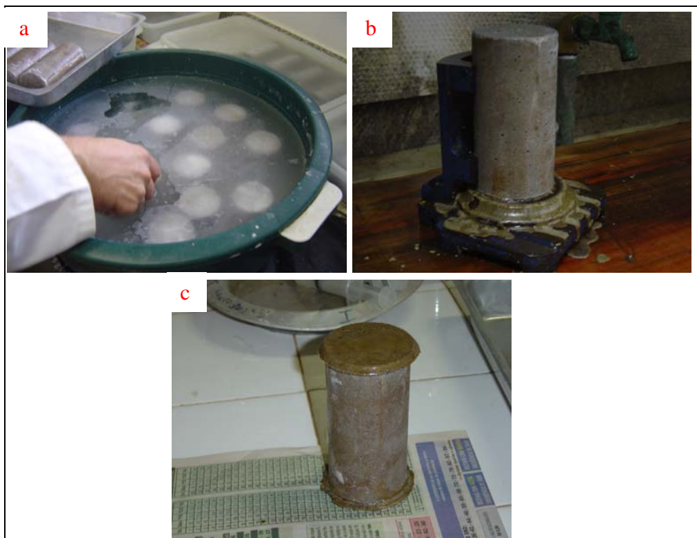
Figura 45: a) Corpos de prova imersos em água saturada com cal; b) Capeamento; c) Corpo de prova com as duas extremidades capeadas.
