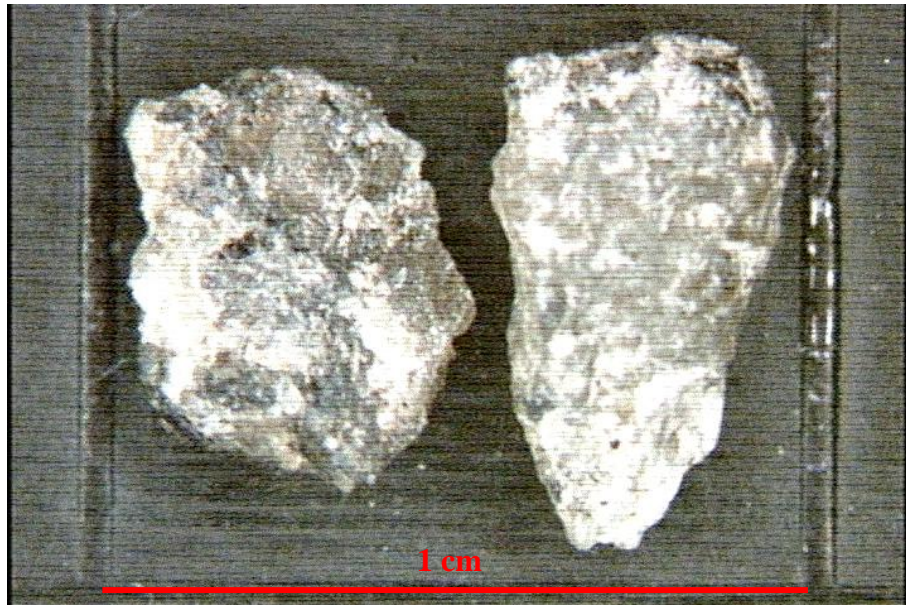
Figura 77: Grãos da amostra Charnokito retidos na peneira #8.
