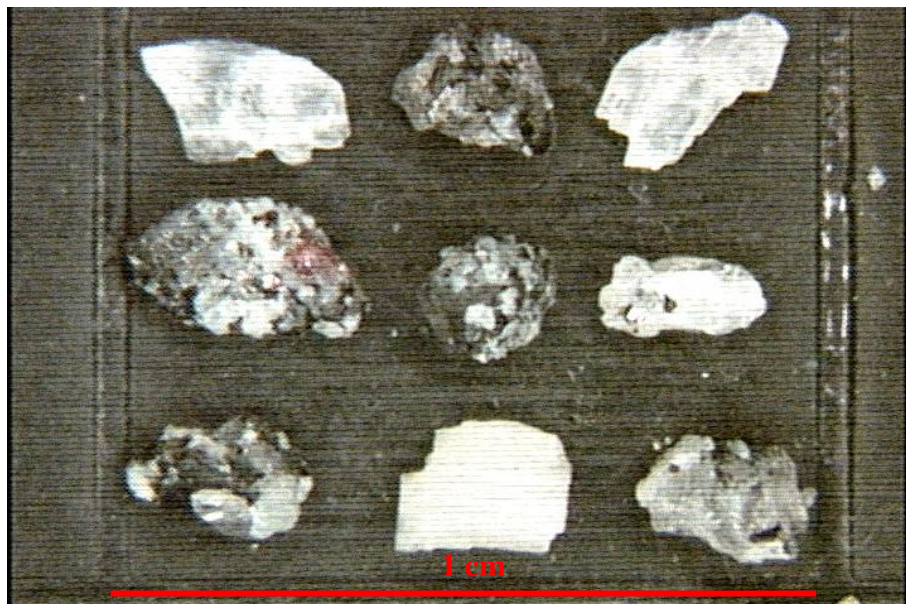
Figura 80: Grãos da amostra Gnaiss facoidal 1 retidos na peneira #16.
