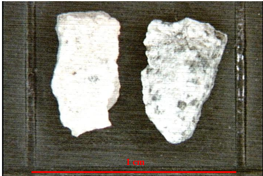
Figura 87: Grãos da amostra Nefelina-sienito retidos na peneira #8.
