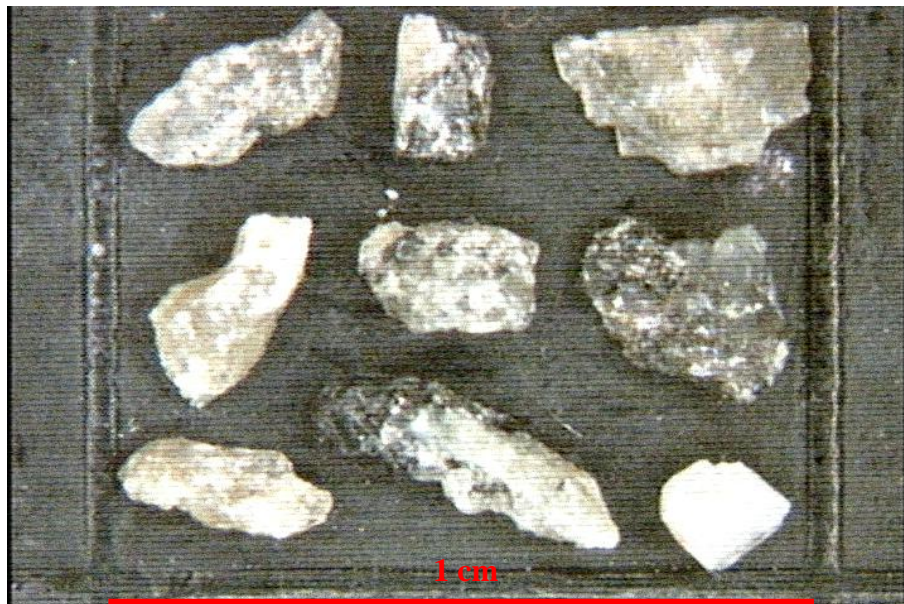
Figura 78: Grãos da amostra Charnokito retidos na peneira #16.
