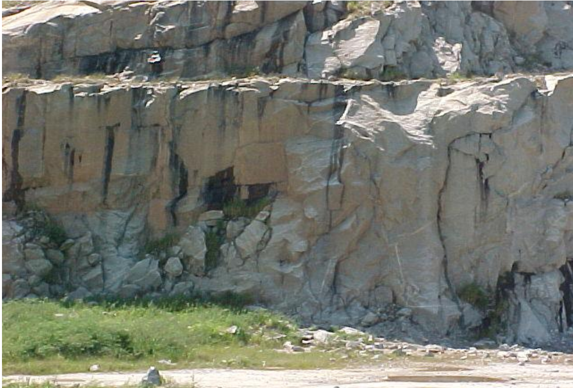
Figura 34: Detalhe do fraturamento irregular nas bancadas da pedreira do Granito-gnaisse.
