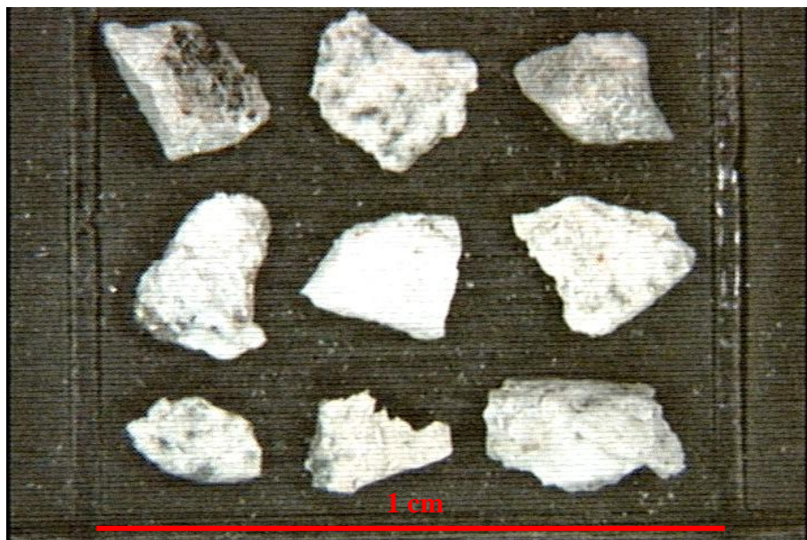
Figura 88: Grãos da amostra Nefelina-sienito retidos na peneira #16.
