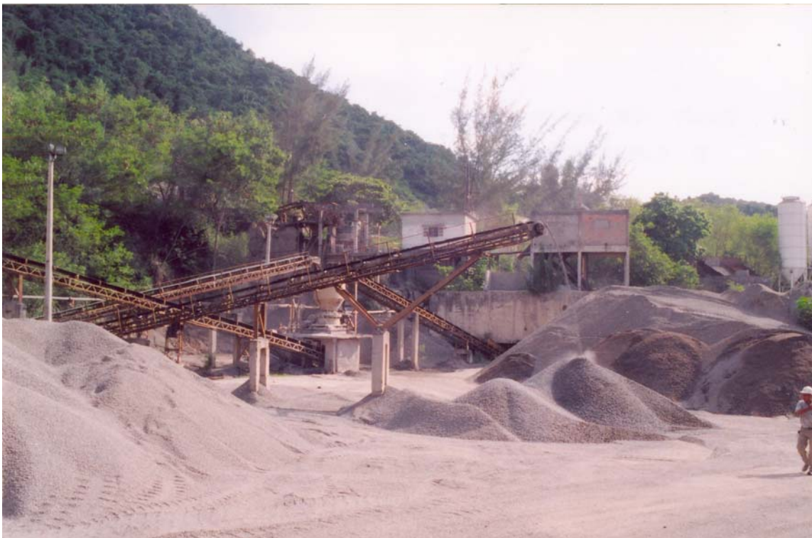
Figura 27: Sistema de britagem e separação dos materiais na pedreira do Gnaiss facoidal 2.
