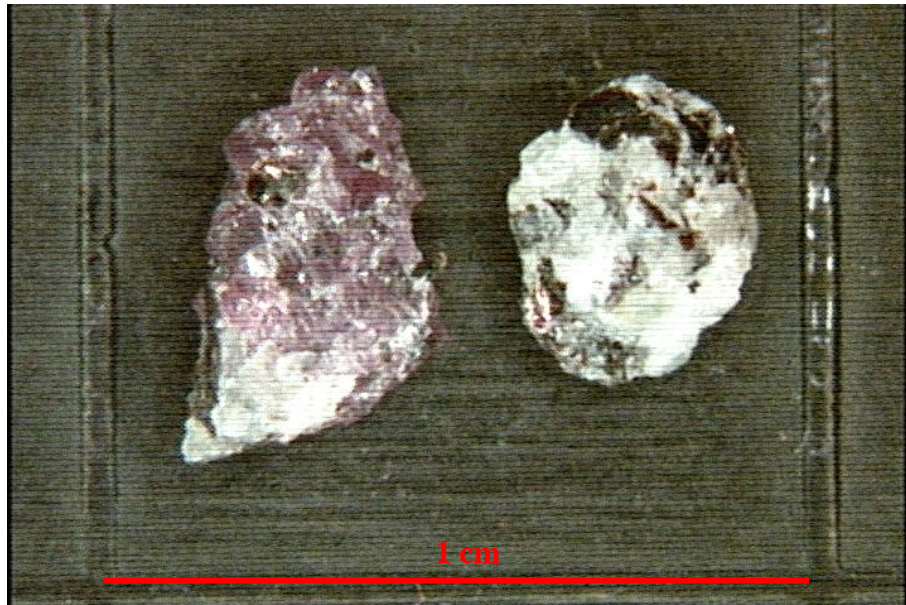
Figura 83: Grãos da amostra Granada-gnaisse retidos na peneira #8.
