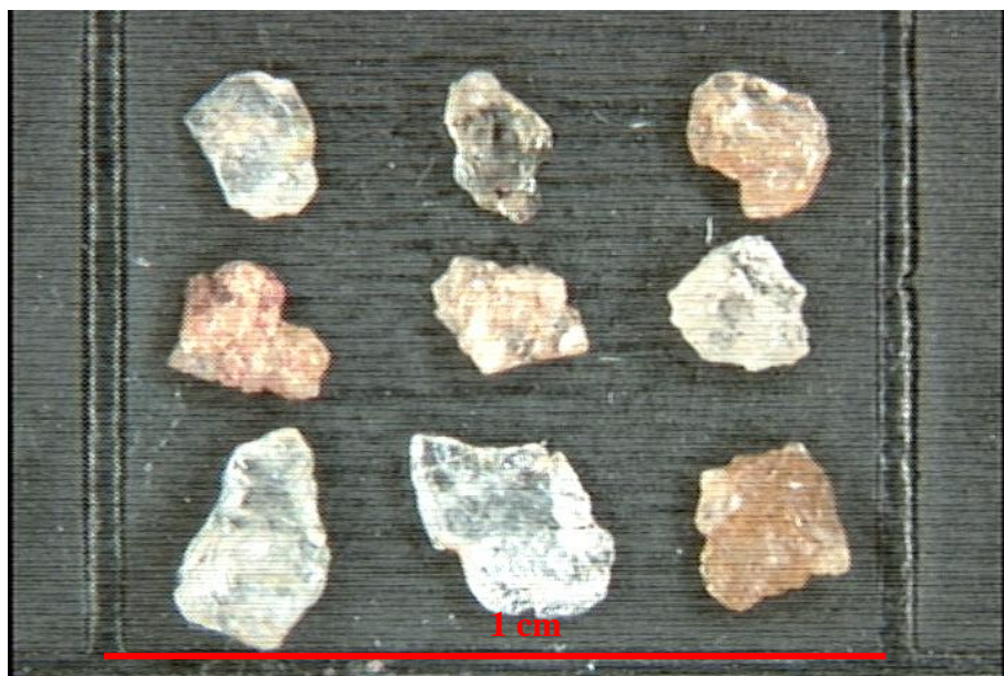
Figura 76: Grãos da amostra Areal 2 retidos na peneira #16.
