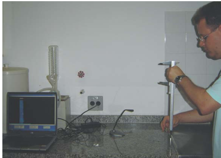
Figura 2.5 – Procedimento experimental. Com um paquímetro é medida a altura inicial de queda da esfera que é solta, e o som produzido pelos seus impactos são captados pelo microfone e registrado pelo computador por meio de programa que possibilite registros sonoros.
