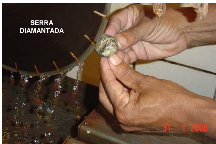
Figura 2.2 – Serra diamantada refrigerada a água utilizada na confecção da esfera.
