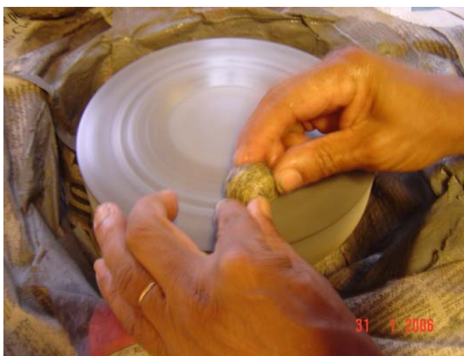
Figura 2.3 – Politriz utilizada no polimento da esfera de rocha.
