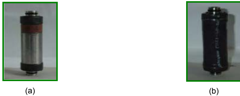
Figura 3.7: Montagem do corpo de prova sobre os caps (a) e aplicação da membrana termoretrátil ao conjunto (b).
