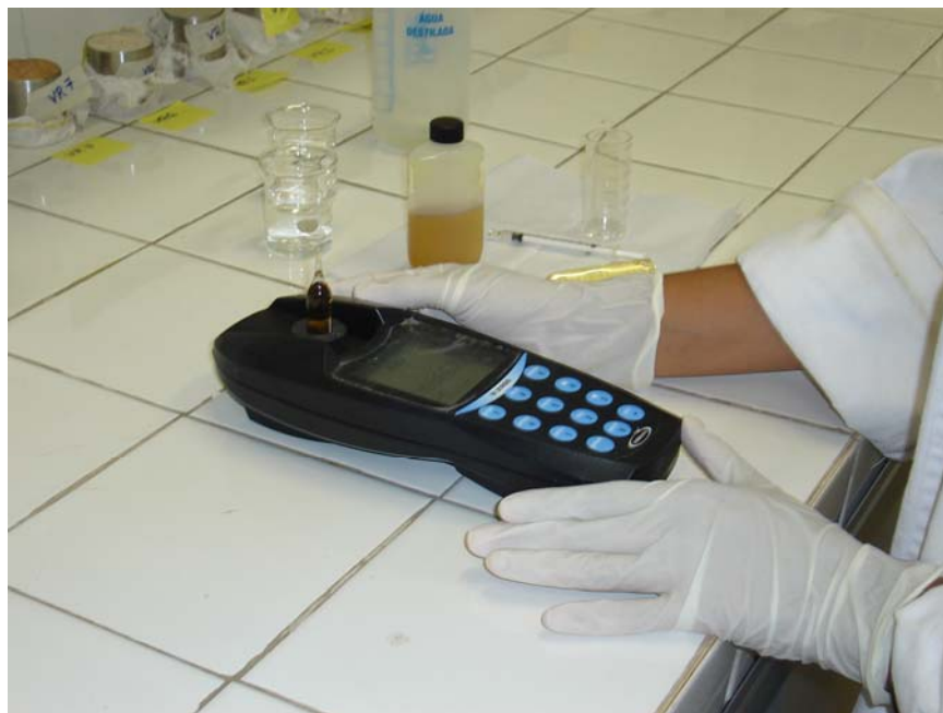
Figura 7 - Medição de cloreto, utilizando o Fotômetro.
