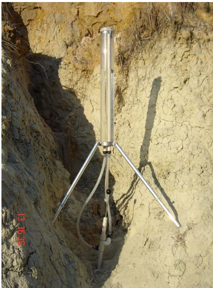
Figura 8 - Permeâmetro de Guelph modificado utilizado in situ , com seus principais componentes.
