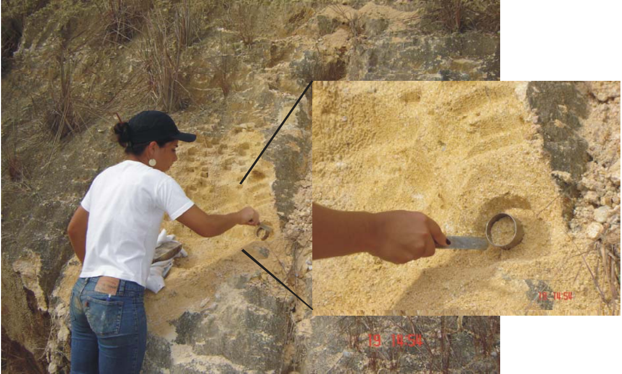
Figura 12 – Coleta de amostra semideformada, em destaque o corpo de prova sendo coletado em um cilindro com 5 cm de comprimento e 20,4 cm 2 de área transversal.
