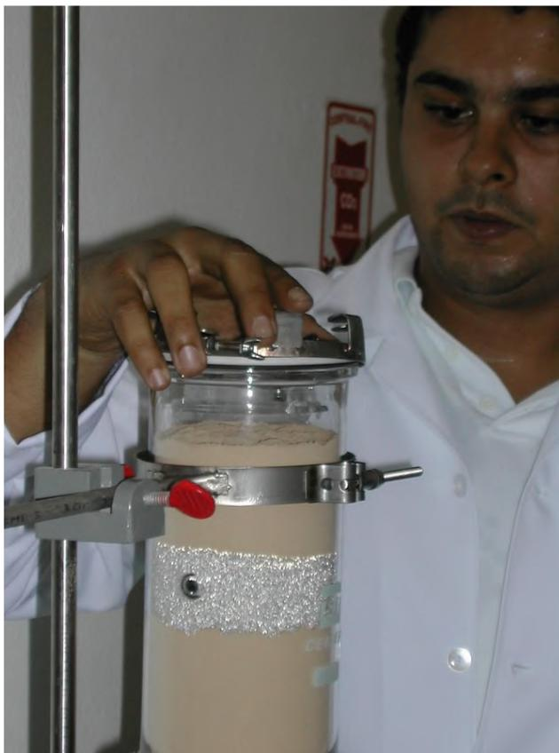
**Figura 20 – Início do desmonte do cilindro para coleta da argila.**
