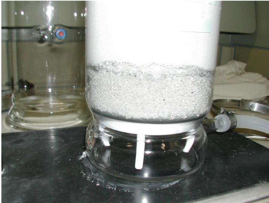
**Figura 47 – Comportamento da caulinita durante injeção dos gases, similar a bentonita.**
