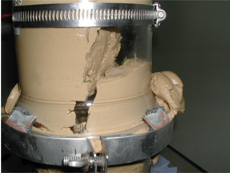
**Figura 42 – Detalhe da desestruturação da mistura na parte interna do cilindro.**
