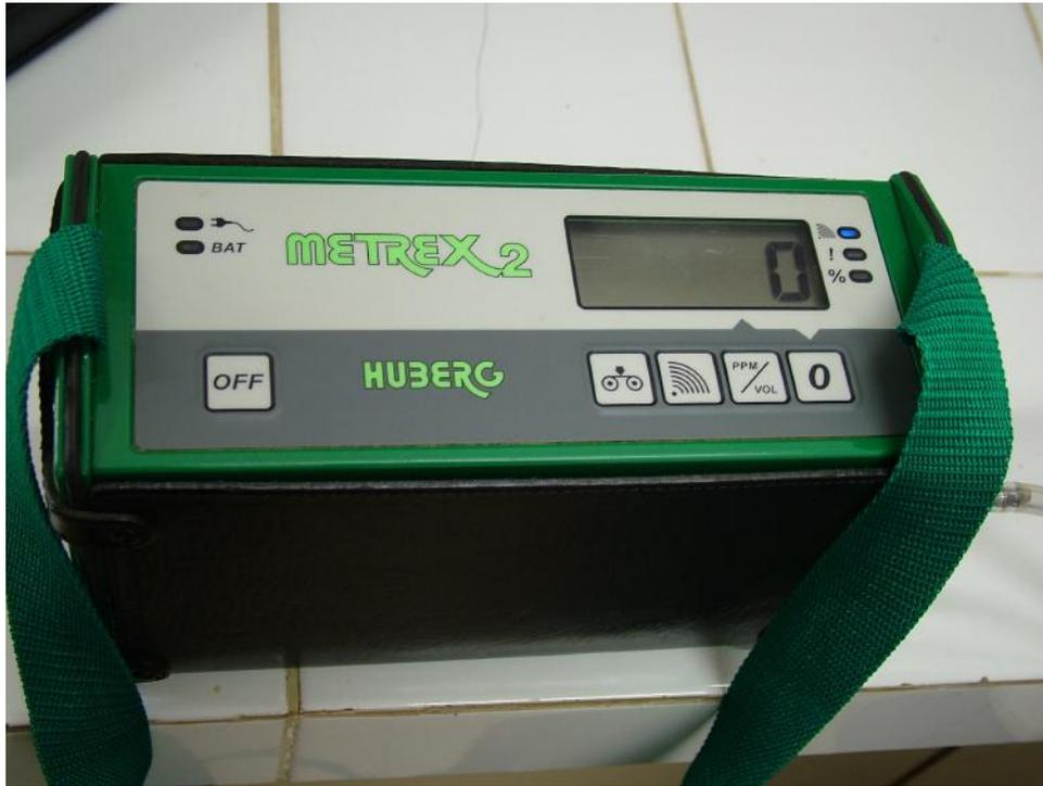
*Figura 33 –Detalhe do aparelho usado para verificar escapamentos dos gases.*
