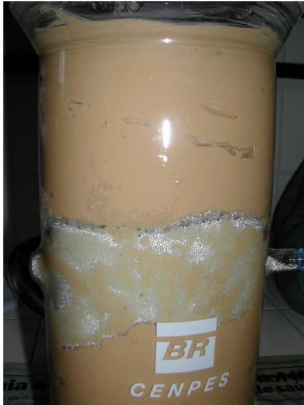
**Figura 37 – Observa-se a dificuldade de preencher o cilindro de modo a não permitir a presença de volumes de vazio.**
