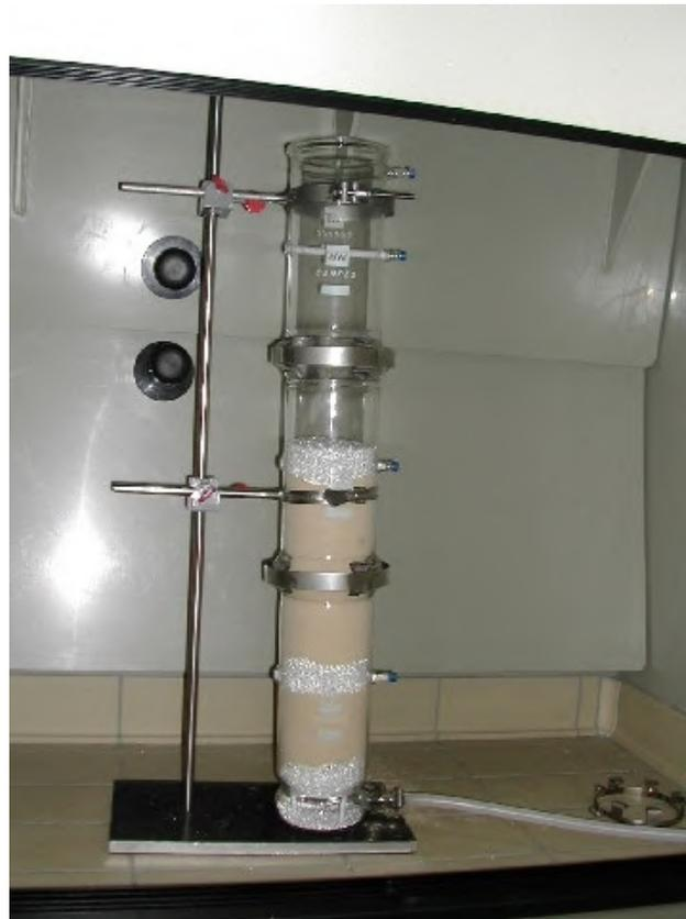
**Figura 16 – Etapa de preenchimento: colocação da segunda camada de microesferas de vidro no cilindro.**
