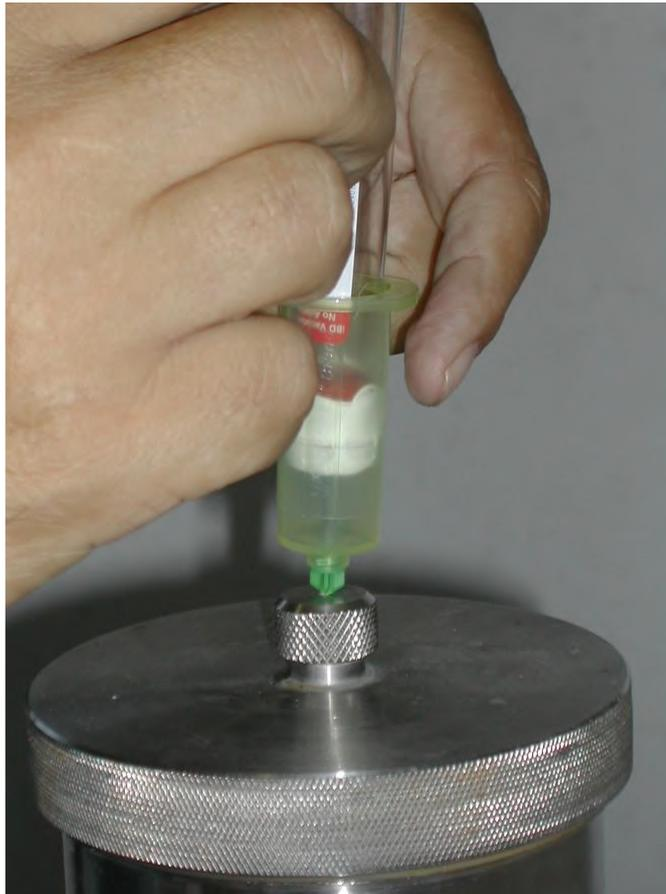
**Figura 28 – Coleta dos gases para análise em amostras do tipo Blender.**
