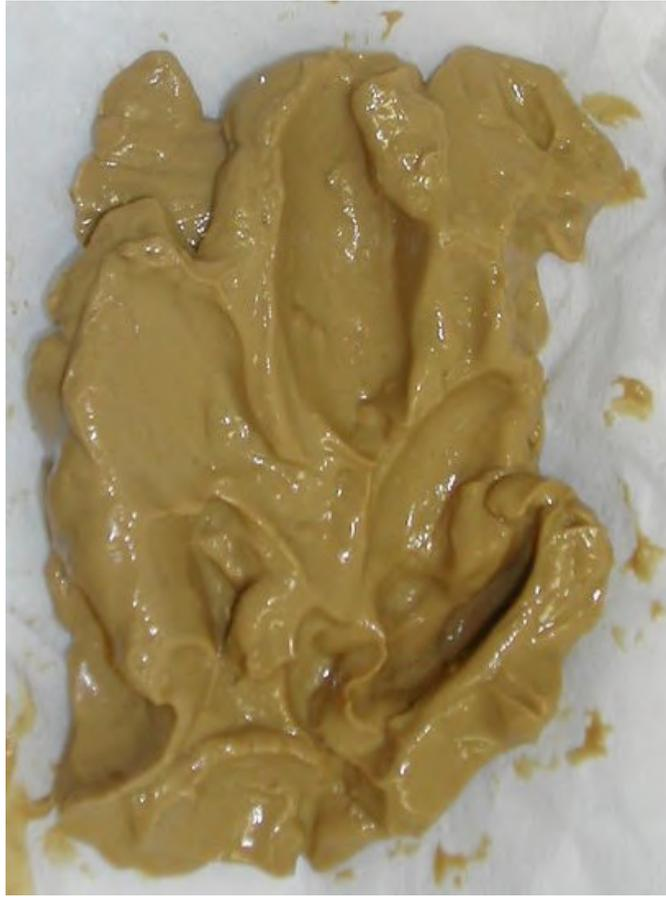
**Figura 35 – Ensaio de preparação de mistura água/bentonita na razão 4:1.**
