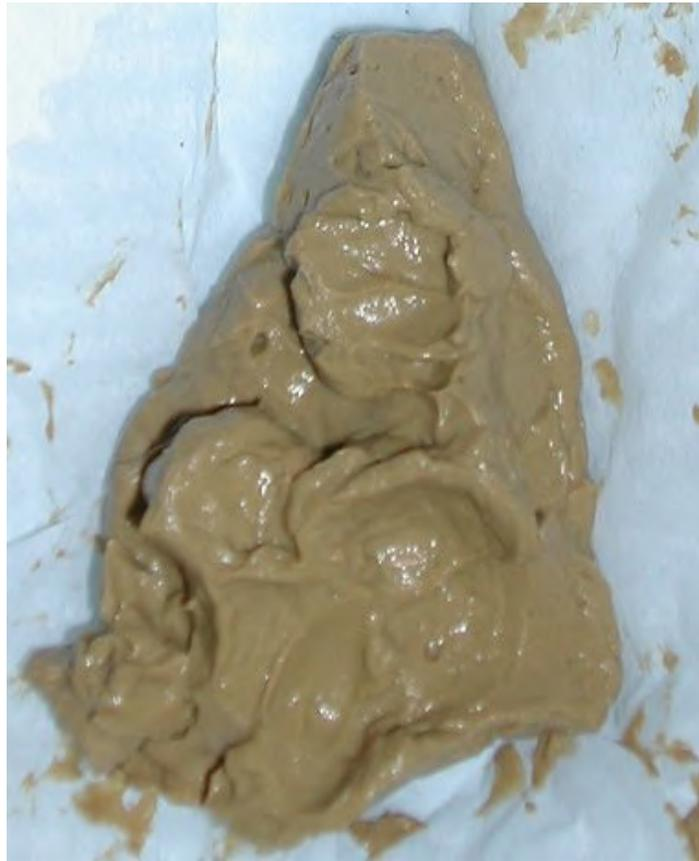
**Figura 39 – Ensaio de preparação de mistura água/bentonita na razão 3:1.**
