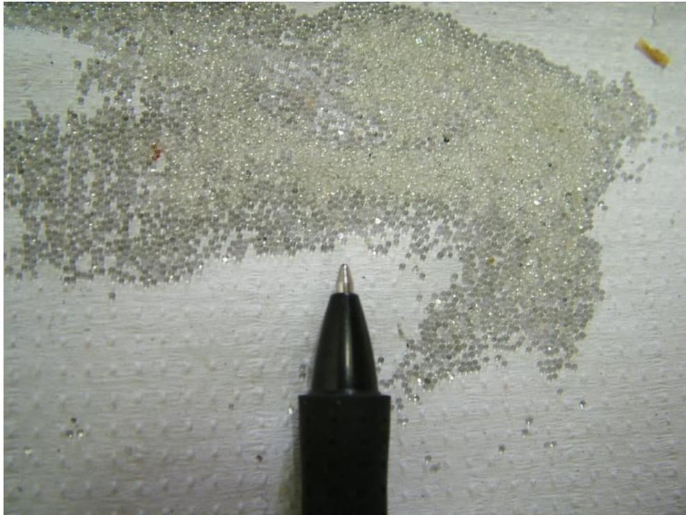
**Figura 6 – Detalhe das microesferas de vidro.**
