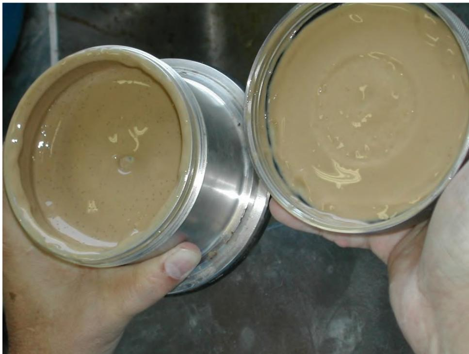
**Figura 27 – Configuração da amostra após ser desagregada.**
