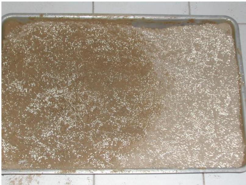
**Figura 51 – Processo de mistura entre bentonita, microesferas de vidro e água. Pode-se observar à esquerda parte mais úmida, dada por coloração mais escura.**
