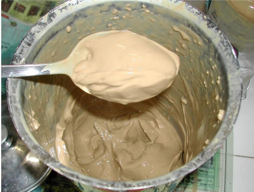
**Figura 38 – Coqueteleira utilizada para preparação de mistura homogênea água/argila.**
