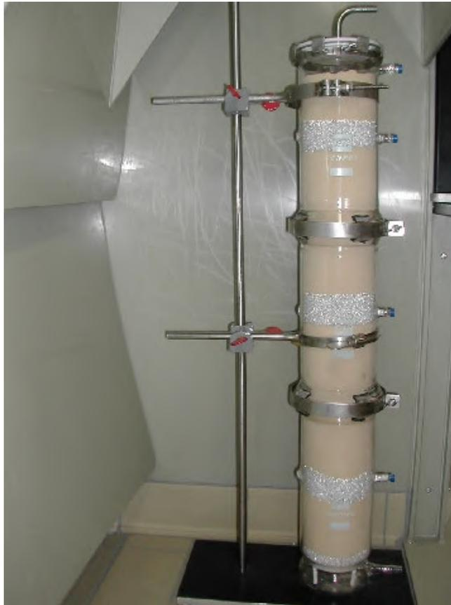
**Figura 17 – Etapa de preenchimento: cilindro preenchido com os sedimentos.**
