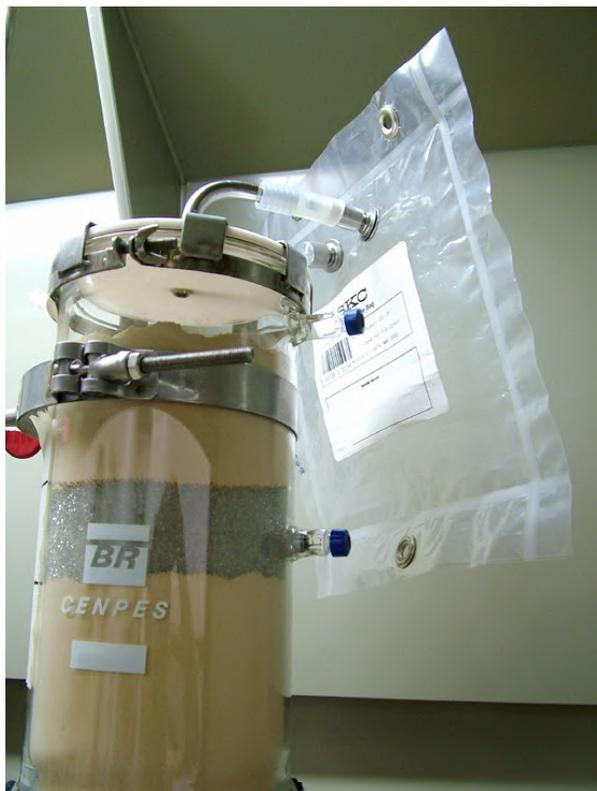
**Figura 5 – Saco de polietileno destinado à amostragem de gases no tubo de purga do cilindro.**
