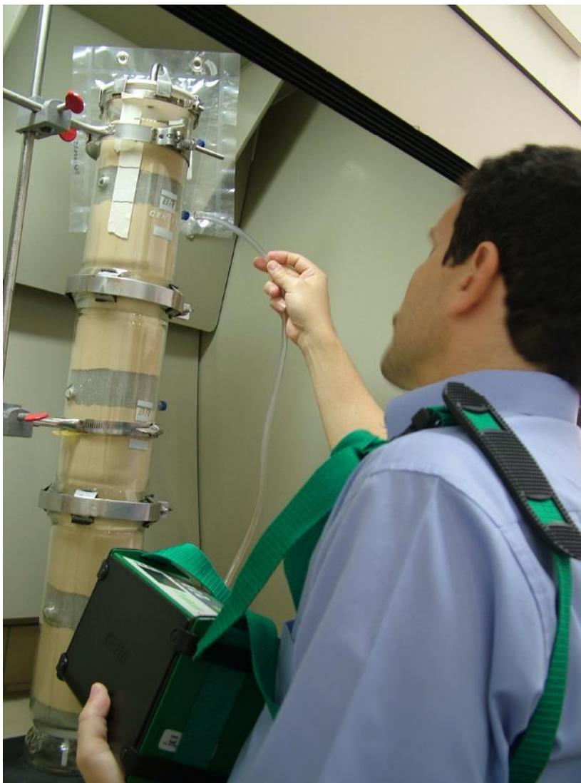
**Figura 34 – Teste para verificar escapamentos dos gases.**
