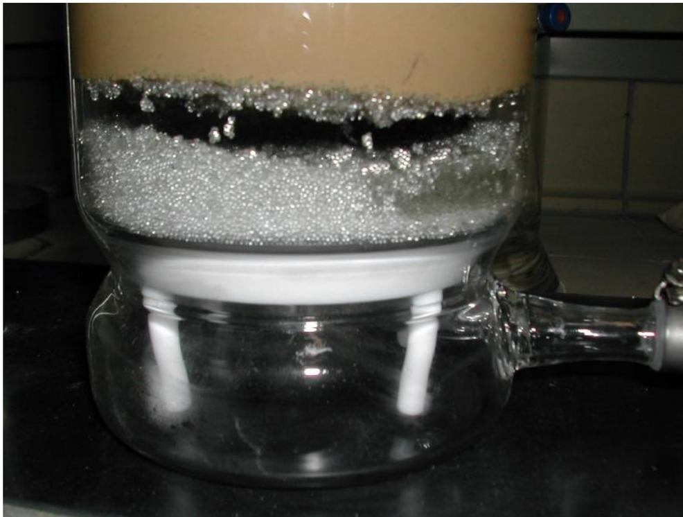
**Figura 43 – Detalhe do fenômeno responsável pelo extravasamento da mistura.**
