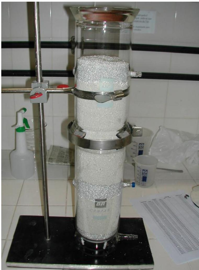
**Figura 50 – Etapa intermediária do preenchimento do cilindro para caulinita fase úmida (umidade 8,2%).**
