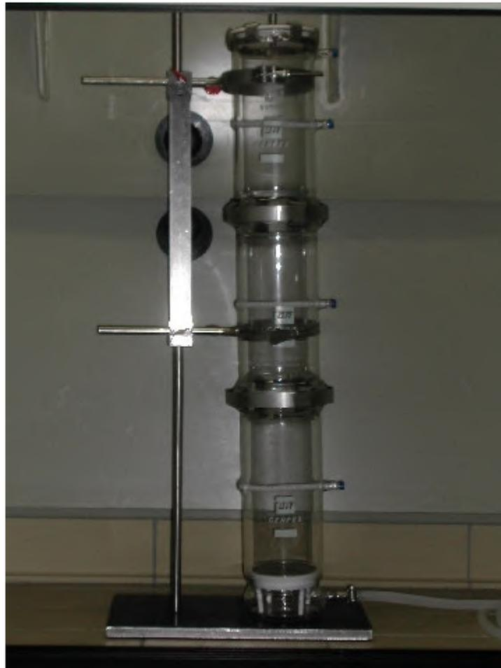
*Figura 11 – Cilindro de vidro após montagem, pronto para receber os sedimentos.*
