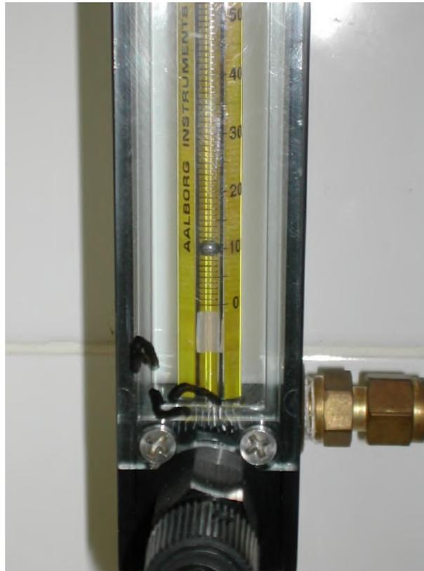
**Figura 19 – Detalhe do rotâmetro operando com vazão no valor 10 equivalente a 2 ml/min.**
