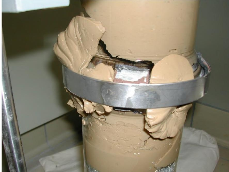
**Figura 41 – Extravasamento da mistura pela junção das seções do cilindro.**
