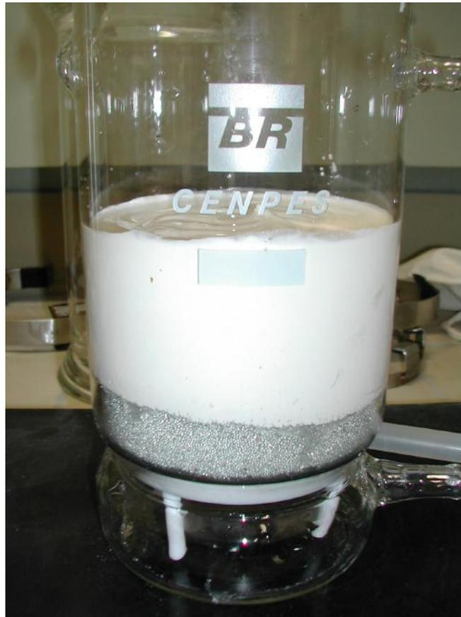
**Figura 46 – Ensaio para verificar comportamento da caulinita saturada durante injeção dos gases.**
