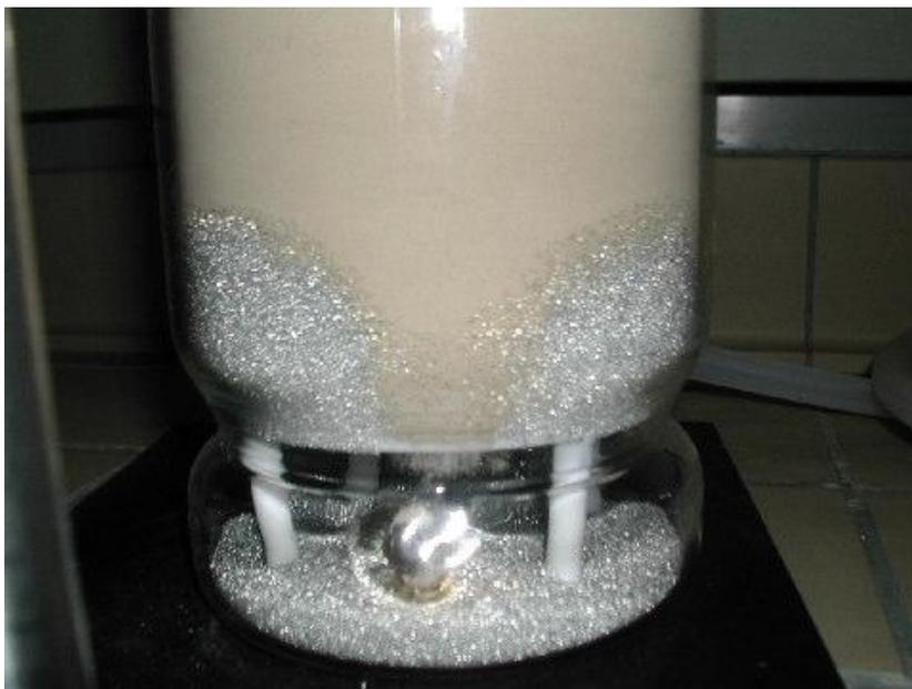
**Figura 31 – Vazamento dos sedimentos para a câmara de Injeção.**
