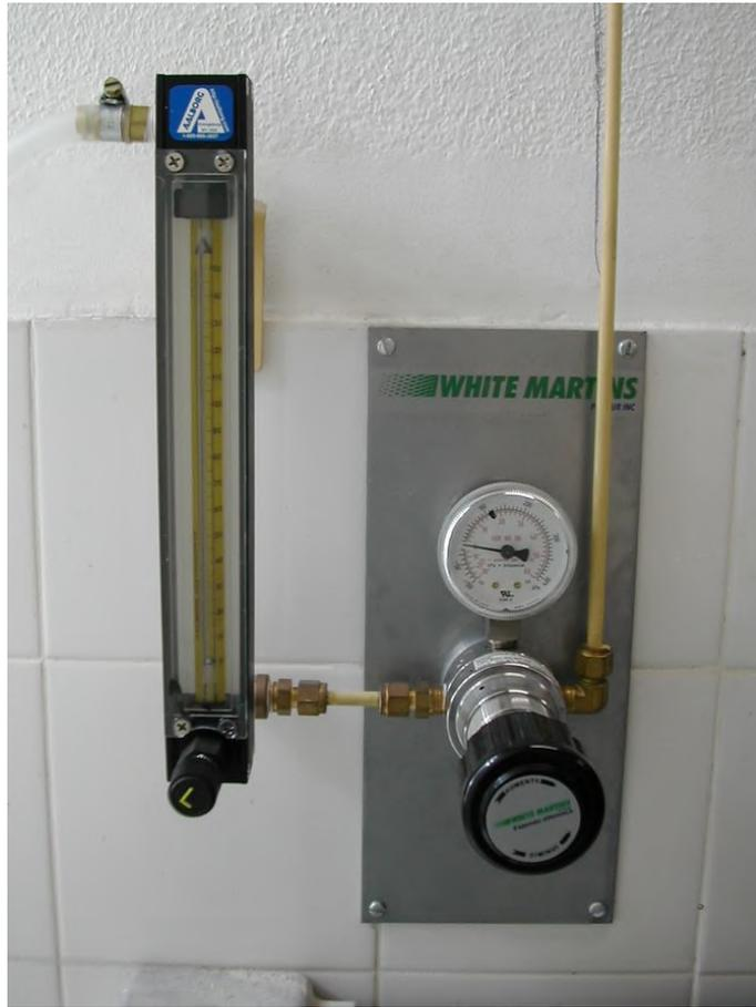
*Figura 18 – Conjunto rotâmetro (esquerda) e regulador de pressão (direita).*
