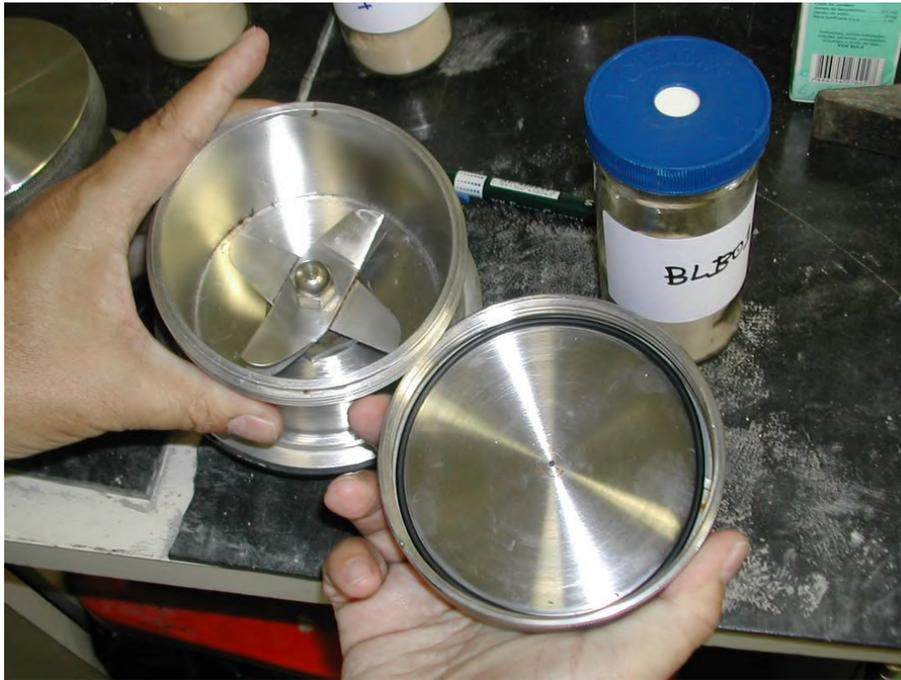
**Figura 26 – Recipiente onde são preparadas as amostras do tipo Blender.**
