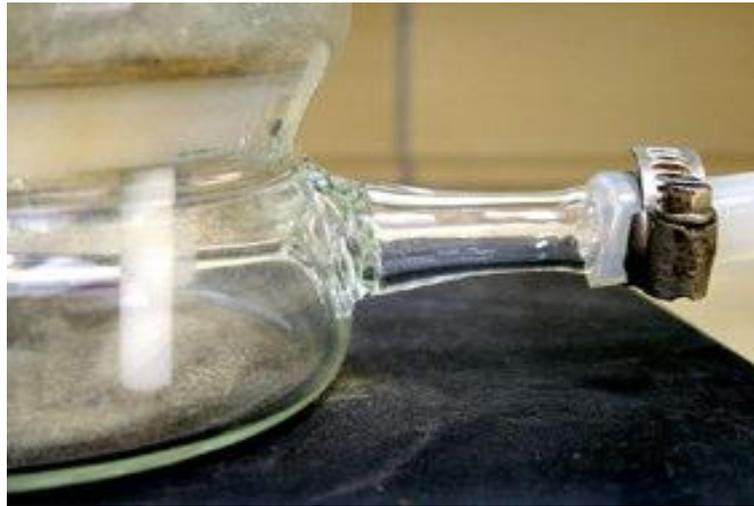
**Figura 3 – Detalhe do apêndice de vidro que recebe os gases de hidrocarbonetos.**
