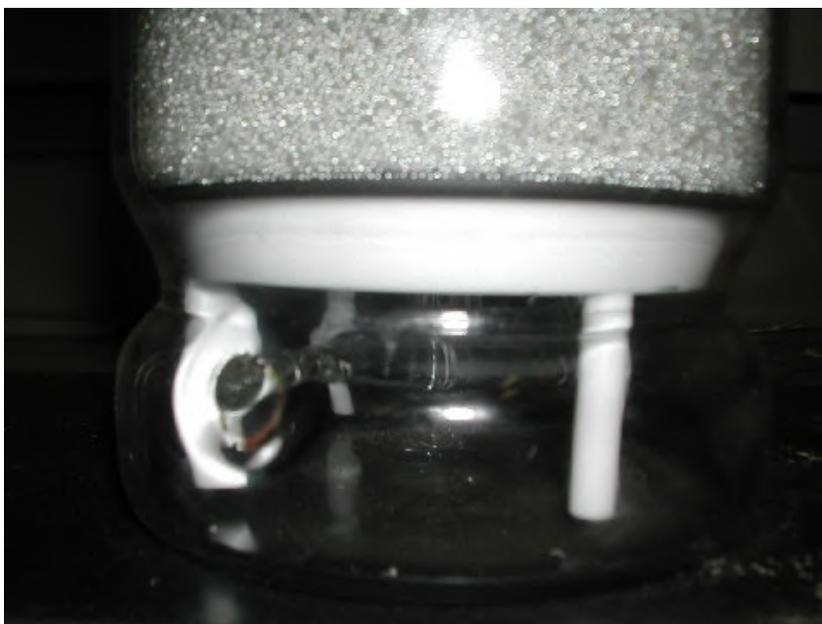
**Figura 32 – Após substituição do anel de vedação não houve vazamentos.**
