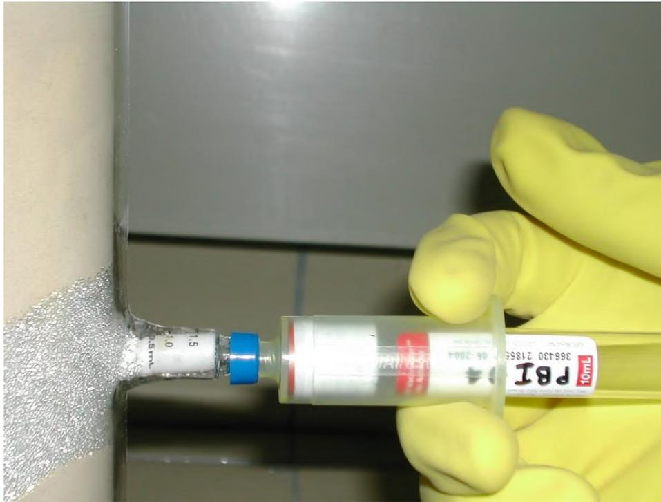
**Figura 22 – Procedimento para a coleta de amostra tipo probe.**
