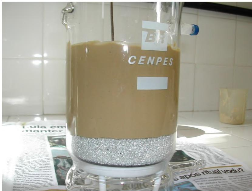
**Figura 40 – Etapa de preenchimento do cilindro para injeção dos gases, na fase saturada.**
