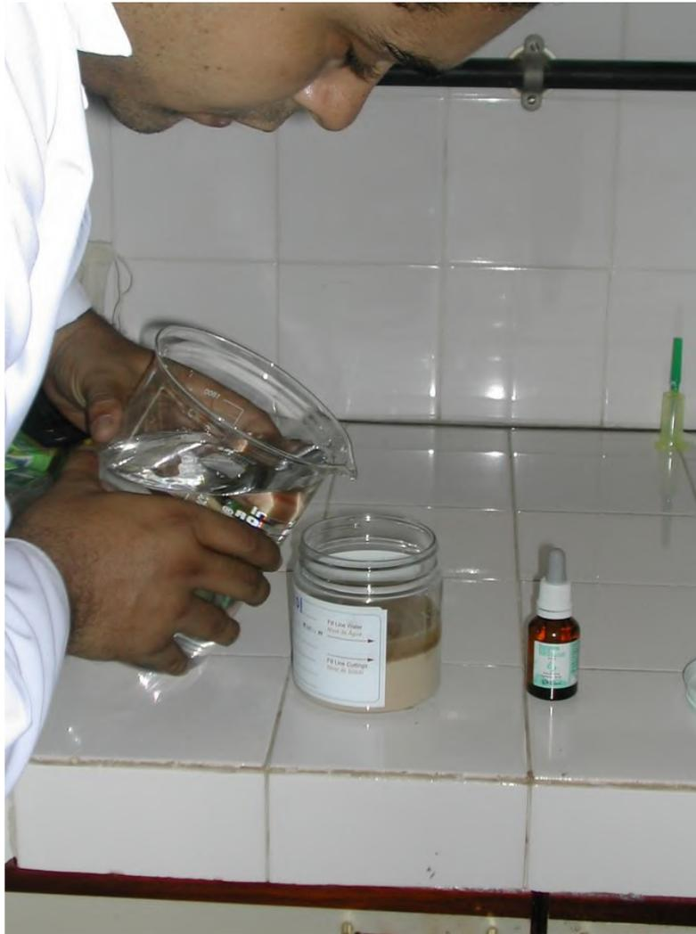
**Figura 25 – Preparação de amostra do tipo headspace. A direita observa-se frasco com o bactericida.**
