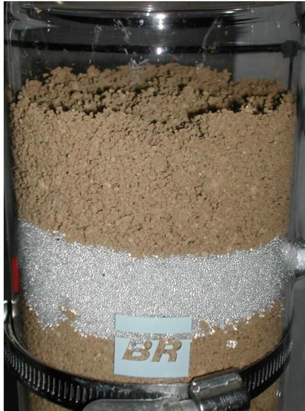
**Figura 52 – Detalhe da estrutura da mistura preparada para bentonita fase úmida (umidade 13,2%).**
