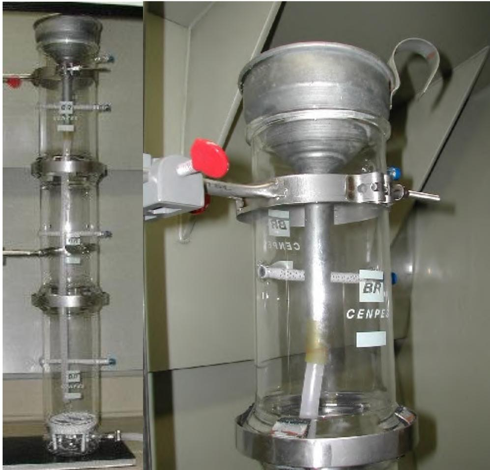
**Figura 14 – (a) Funil acoplado a mangueira, utilizados para o transporte dos sedimentos até o nível inferior do cilindro. (b) Detalhe do conjunto acoplado.**
