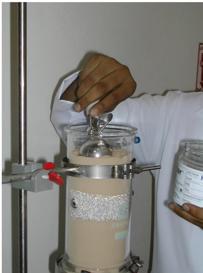
**Figura 24 – Coleta da argila para amostra tipo headspace.**
