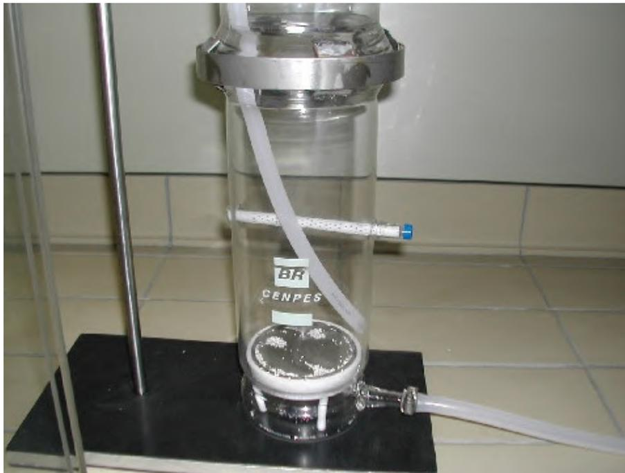
**Figura 12 – Início do preenchimento do cilindro com as microesferas de vidro.**
