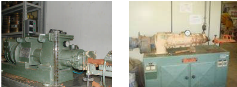
Figura 8 Foto representativa da extrusora a vácuo do IME e da UENF. (fotografia do autor)
