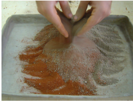
Figura 4 Mistura manual dos solos. Nesta foto mistura de 50%LA x 50%G (fotografia do autor)
