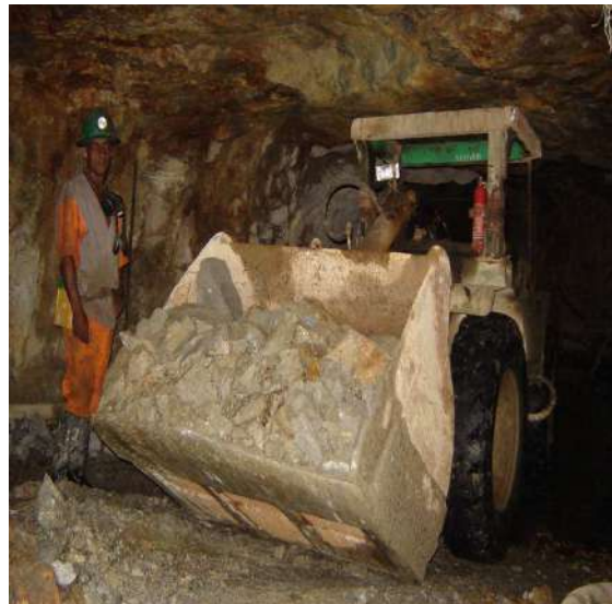
Figura 4: retirada de minério da frente de lavra, utilizando carregadeiras LHD.
