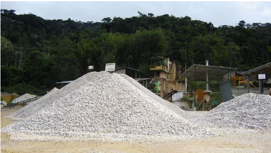
Figura 6: pilha de estocagem de minério, separado de acordo com especificações.
