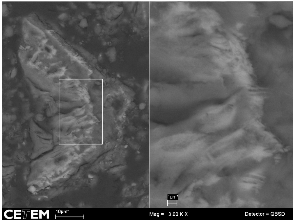
Figura 15: Anfibólio do Grupo I (Mg-Fe-Mn-Li), contendo níquel, em transformação para mineral fibroso ou lamelar.
