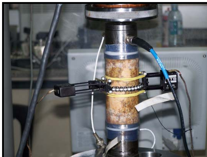
Figura 2 - Ensaios simultâneos de Compressão Uniaxial e Medida de Propagação de Ondas.
