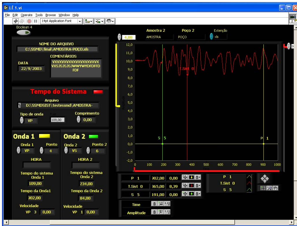
Figura 5 - Módulo de configuração do Sistema de Medidas Estáticas e Dinâmicas Simultâneas (Ferreira & Soares, 2008).
