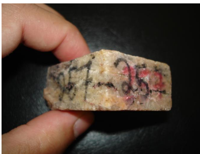
Figura 17: Amostra de gnaiss com fissuras se propagando paralelamente a direção da foliação.
