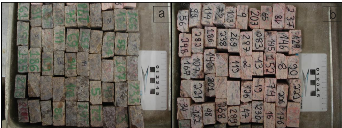
Figura 8: Amostras de charnockitos (a) e gnaisses (b) submetidas a ação de ciclagem água/estufa.
