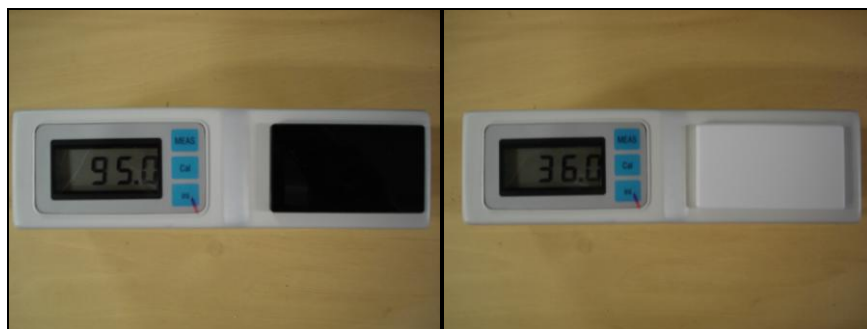
Figura 5: O medidor de brilho WGG-60 e suas duas placas polidas de calibração. O valor do brilho superficial de cada uma delas está exposto no visor.
