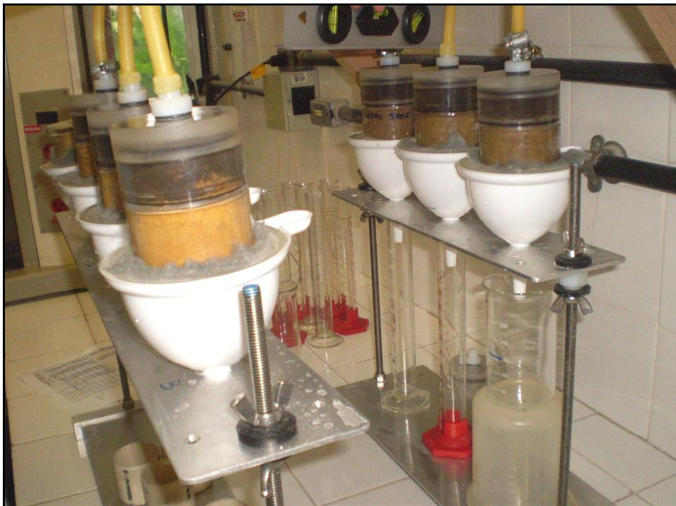
**Figura 7: Sistema de filtração do percolado no ensaio de coluna de percolação.**
