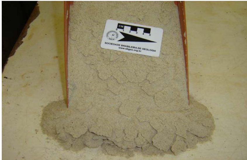
Figura 27. Placas de sal formadas devido a sucção osmótica em ensaio com sal.
