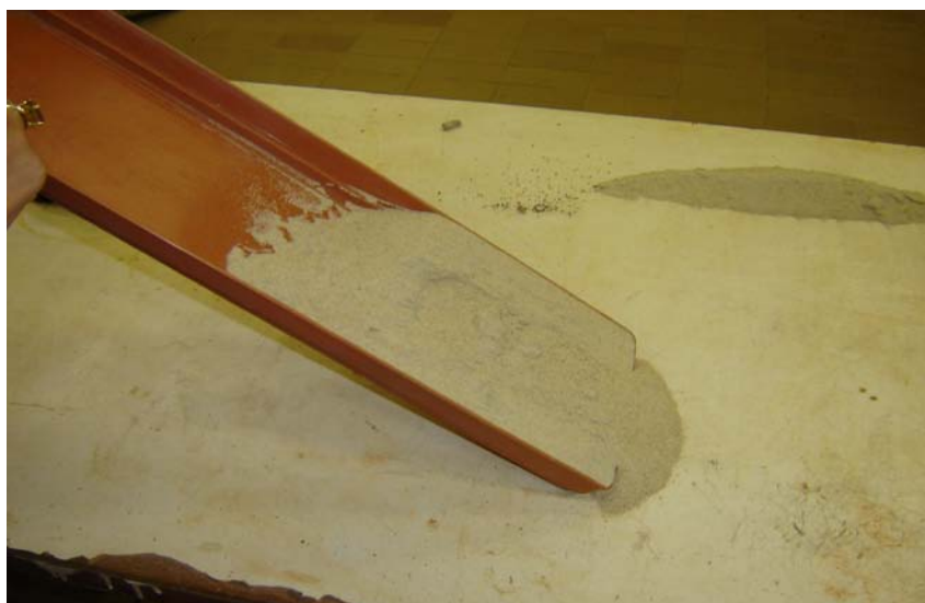
Figura 26. Ensaio de inclinação em amostra sem sal.
