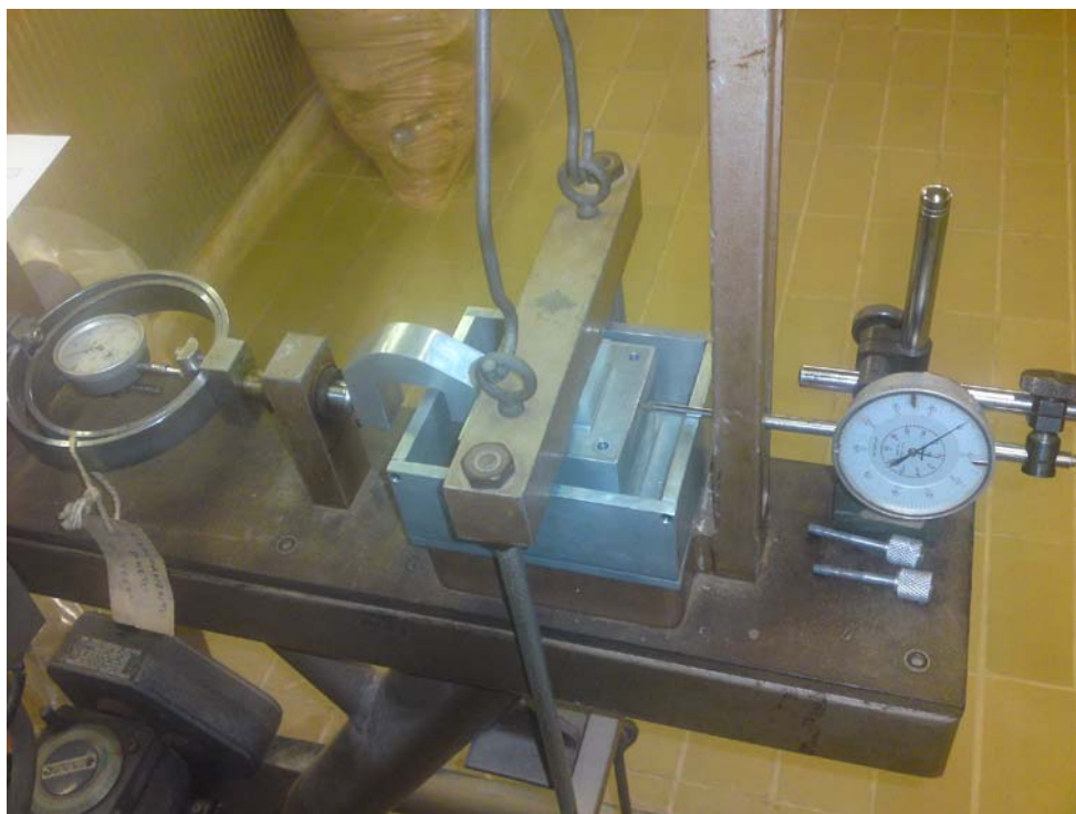
Figura 10. Extensômetro do anel e o de deslocamento da parte superior da caixa.
