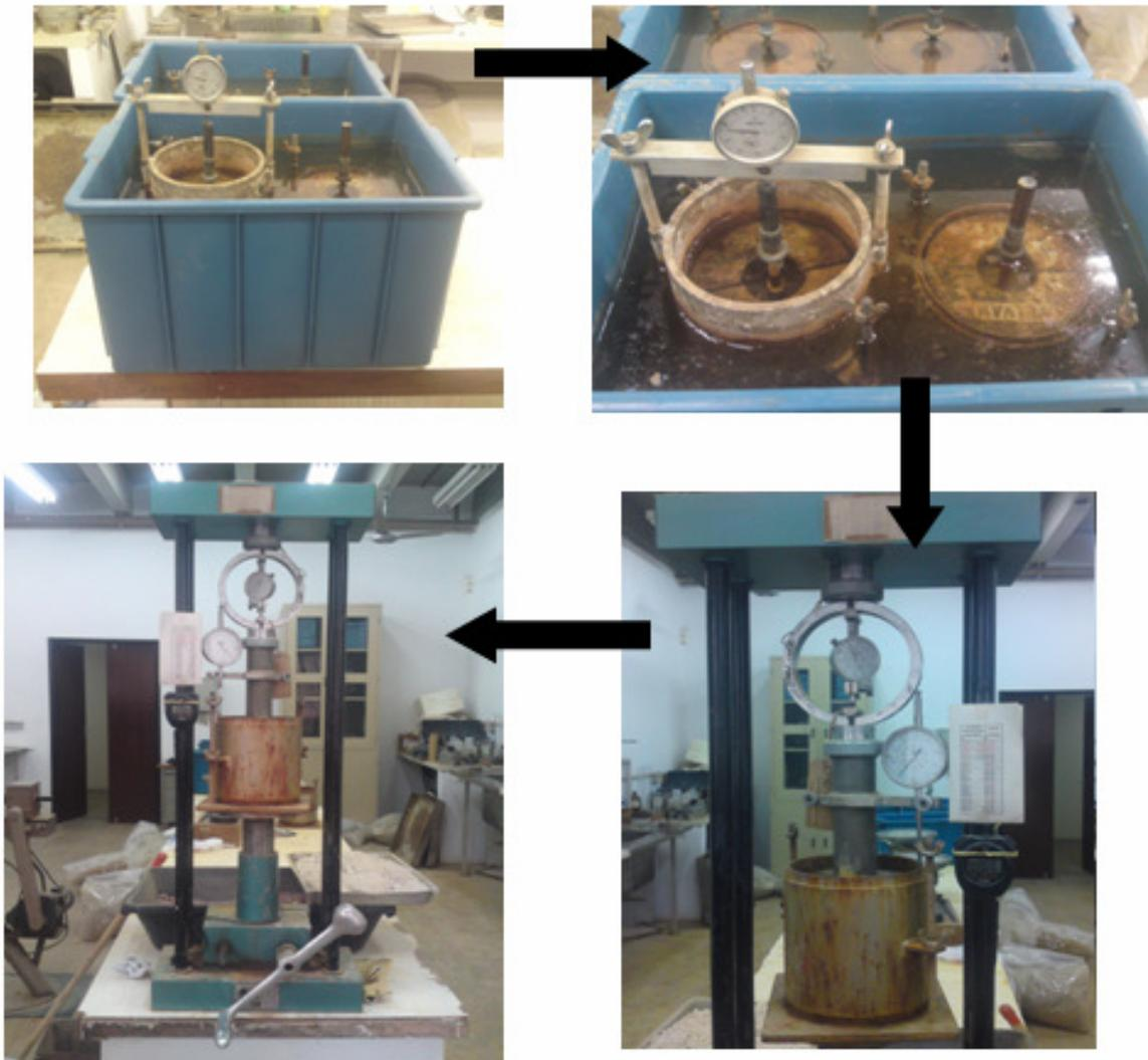
**Figura 6. Ilustração das etapas de submersão dos corpos de prova e realização do CBR.**
