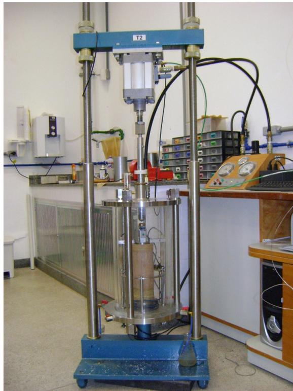
**Figura 7. Ensaio Triaxial de Resiliência.**
