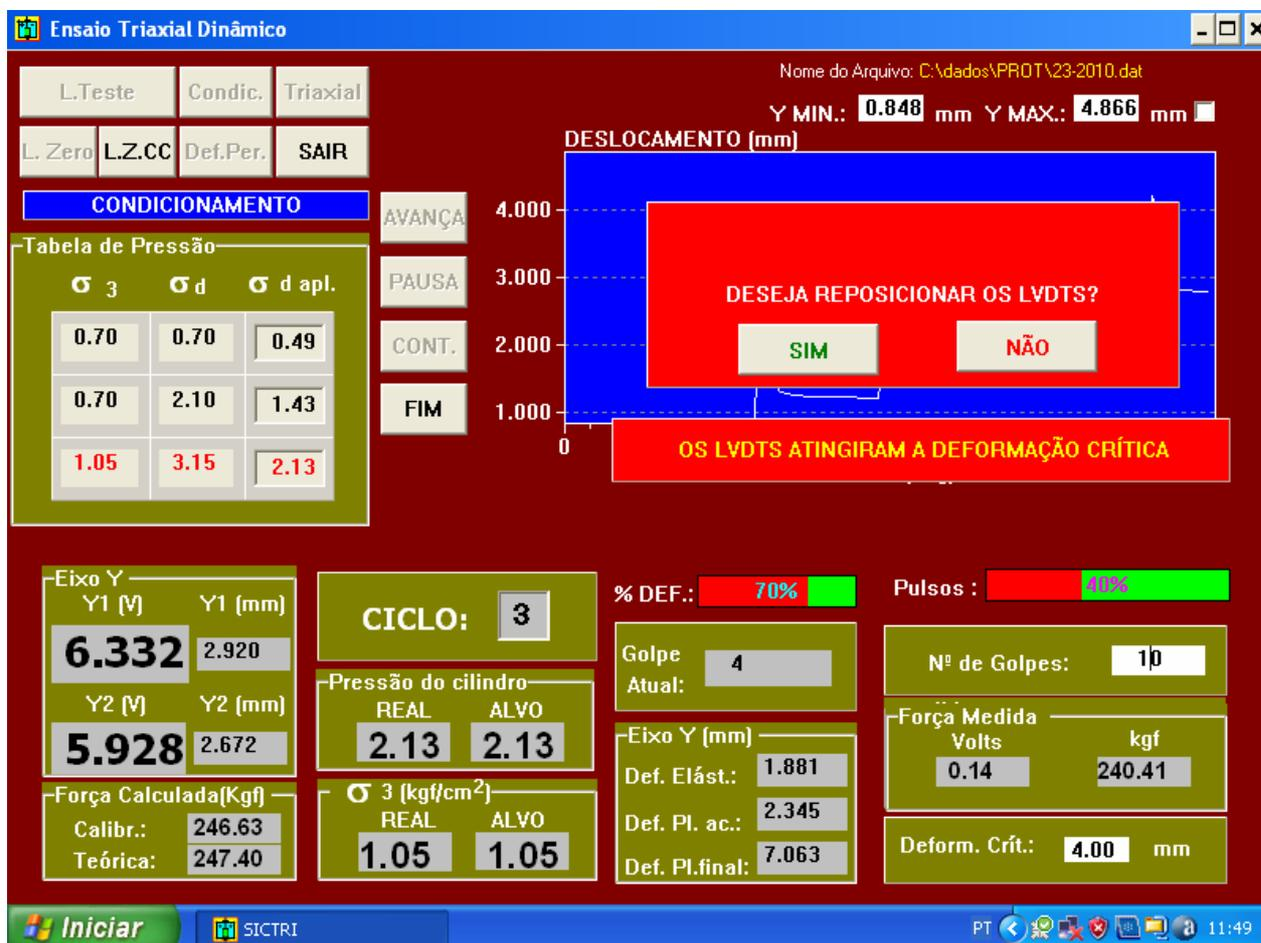
Figura 11. Imagem do programa de computador do ensaio de Módulo de Resiliência.
