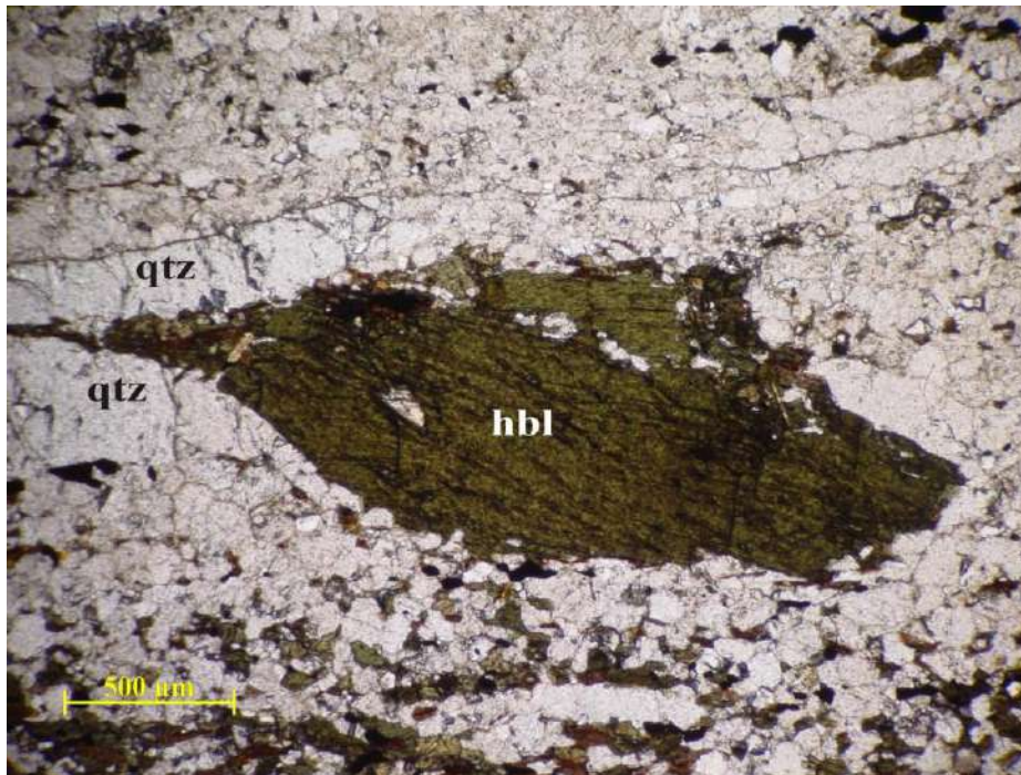
Figura 24- Fotomicrografia a nicóis paralelos com porfiroclasto de hbl verde escura em textura milonítica (BP-17).
