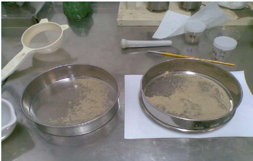
Figura 43: Amostra que passou na peneira de 140 mesh (esq.) e o que ficou na peneira (dir.).
