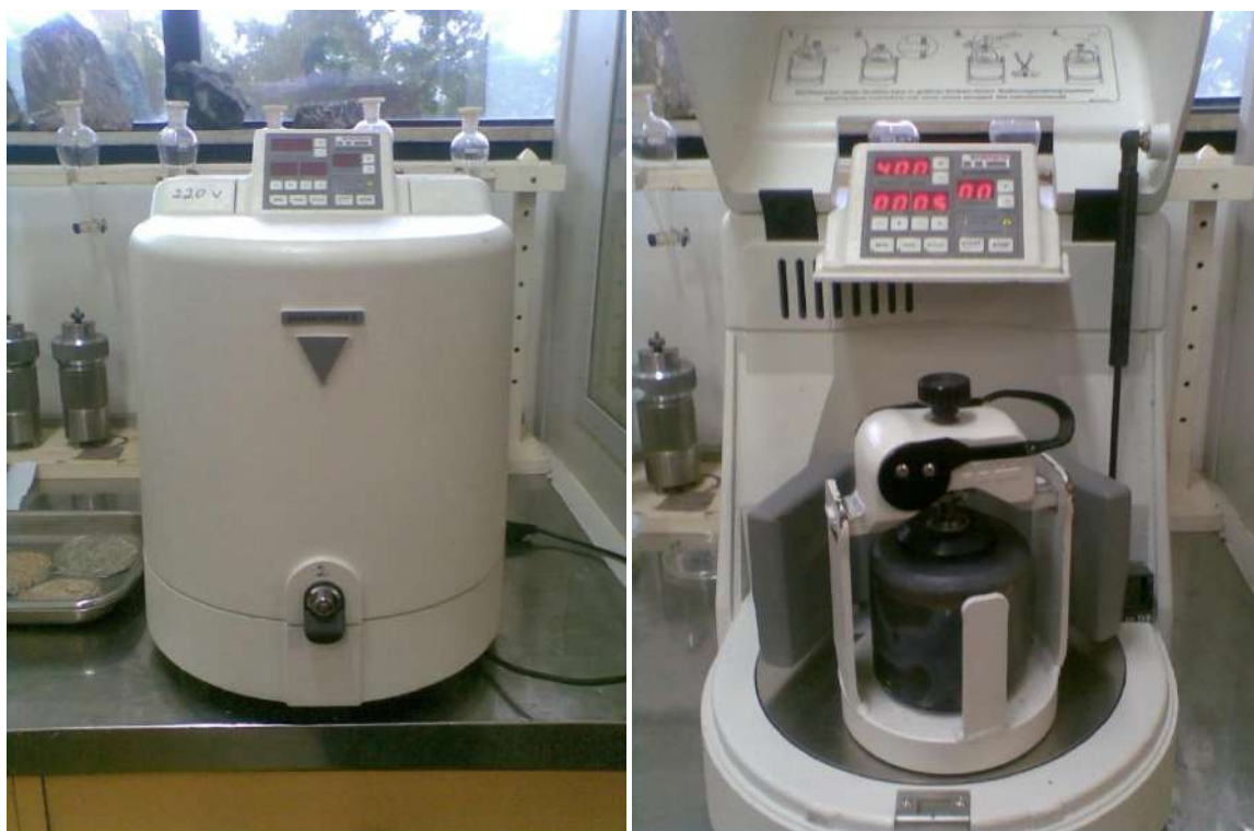
Figura 40: Centrífuga fechada (esq.) e com o recipiente de ágata acoplado (dir.).
