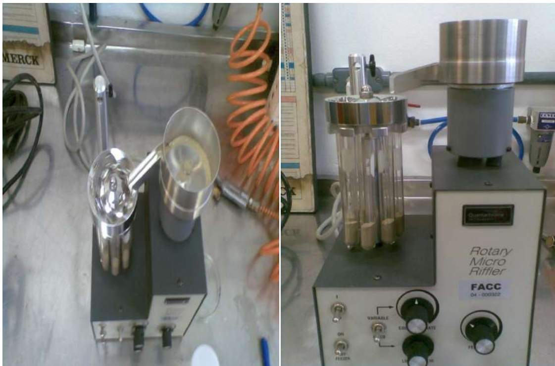
Figura 37: Quarteador em funcionamento visto de cima (esq.) e de frente (dir.).
