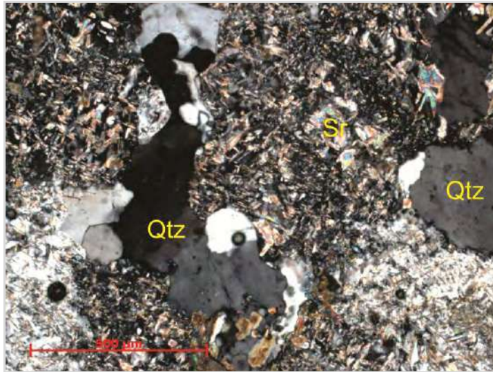
Figura 65 – Plagioclásio fortemente sericitizado no ortogneisse trondhjemítico Canoas (ponto ST-37). Nicol cruzado. Qtz = quartzo; Sr = sericita.
