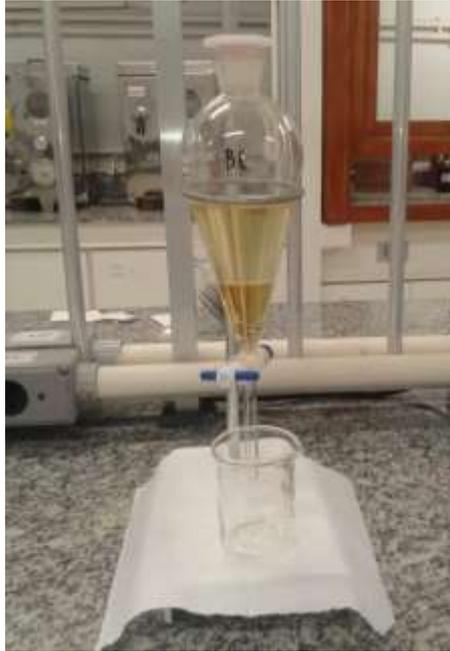
**Figura 11:** Etapa de separação na produção de biodiesel, após 24 h de repouso, mostrando as duas fases formadas.
