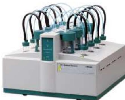
**Figura 13:** Equipamento utilizado para as análises de estabilidade à oxidação do biodiesel – RANCIMAT da Metrohm.
