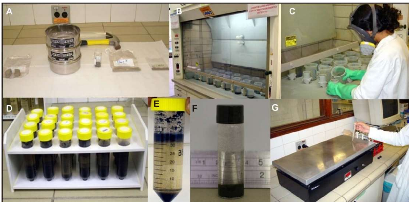
Figura 13: Procedimentos para a preparação das amostras: (A): fragmentação das amostras; (B e C): acidificação com HCl e HF e posterior neutralização; (D): separação por flotação com \text{ZnCl}_2 ; (E): querogênio isolado; (F): concentrado da matéria orgânica; (G): preparação das lâminas organopalinofaciológicas. Extraído de Mendonça Filho et al. (2010a).
