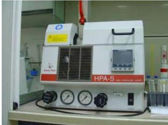
**Figura 4.** Digestor de alta pressão e temperatura (HPA-S).
