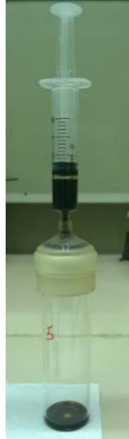
**Figura 9.** Sistema de filtração das amostras de petróleo.
