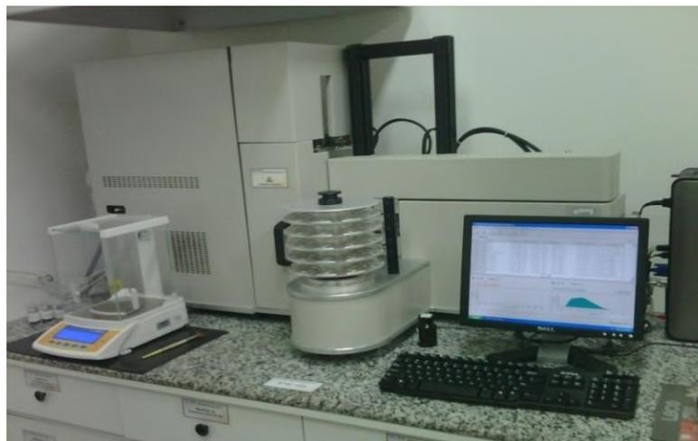
**Figura 5.** Analisador de carbono/enxofre SC 632 da Leco.
