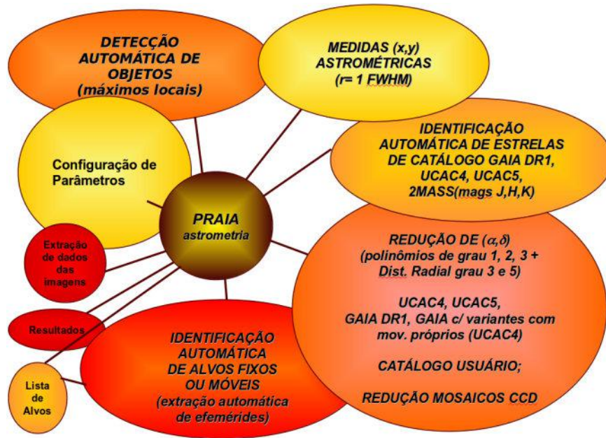
Figura 2.1: Esquema ilustrativo do pacote PRAIA: a sequência a ser seguida pelo PRAIA está no sentido horário, desde a extração dos dados das imagens, até a identificação dos alvos nos campos CCD e, conseqüentemente, a obtenção de resultados.
