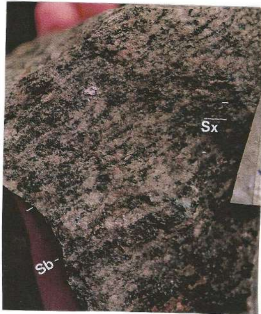
Gnaiss sienítico mesocrático exibindo Sb – bandamento parcialmente obliterado por quartzo – feldspato róseo. Sx – foliação trunca Sb, MTL – 128.
