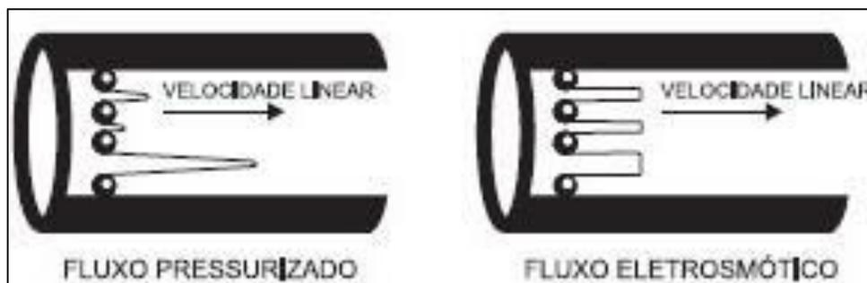
Figura 4: Comparação entre o aspecto do fluxo pressurizado e fluxo eletrosmótico (Bonato et al., 2005)
