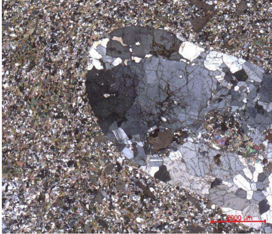
Figura 39 – Granito equigranular pós-tectônico em contato definido com porção máfica, composta principalmente por hornblenda, biotita e plagioclásio (NX, aumento de 2,5X).
