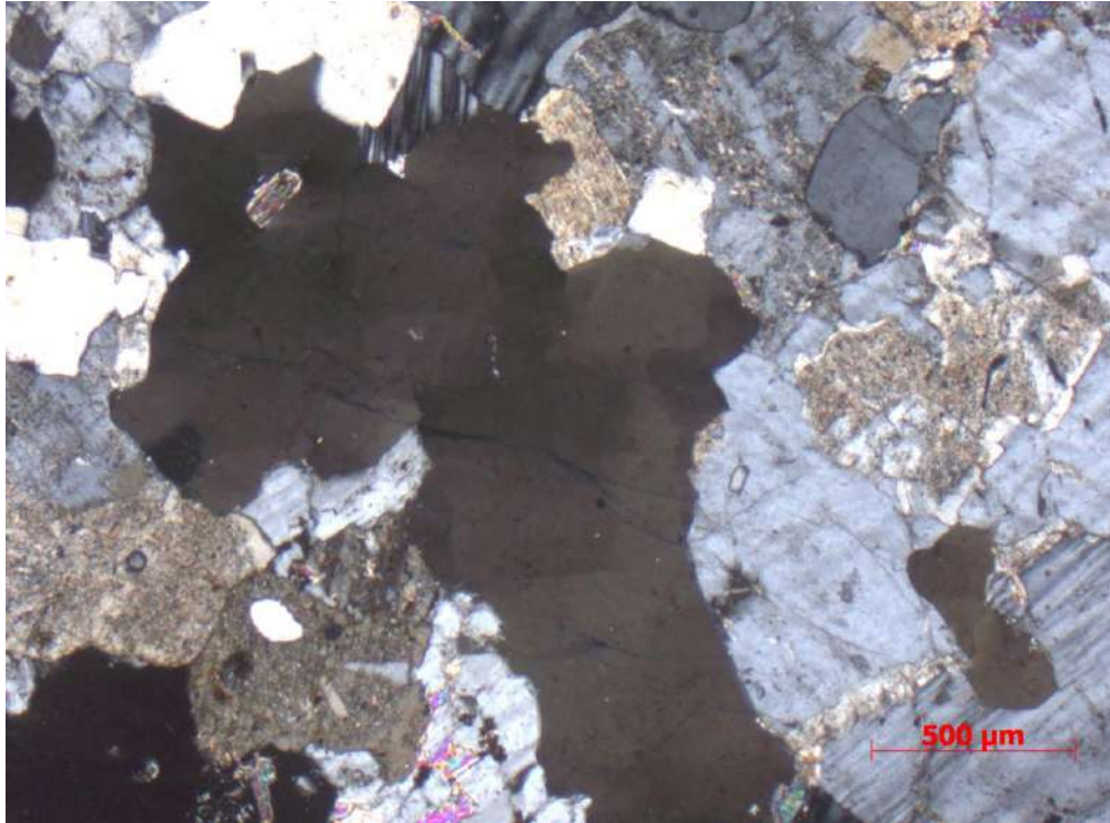
Figura 26 – Grão de quartzo do granitóide foliado fino da Suíte Desengano com extinção ondulante e bordas irregulares (NX, aumento de 2,5 X).
