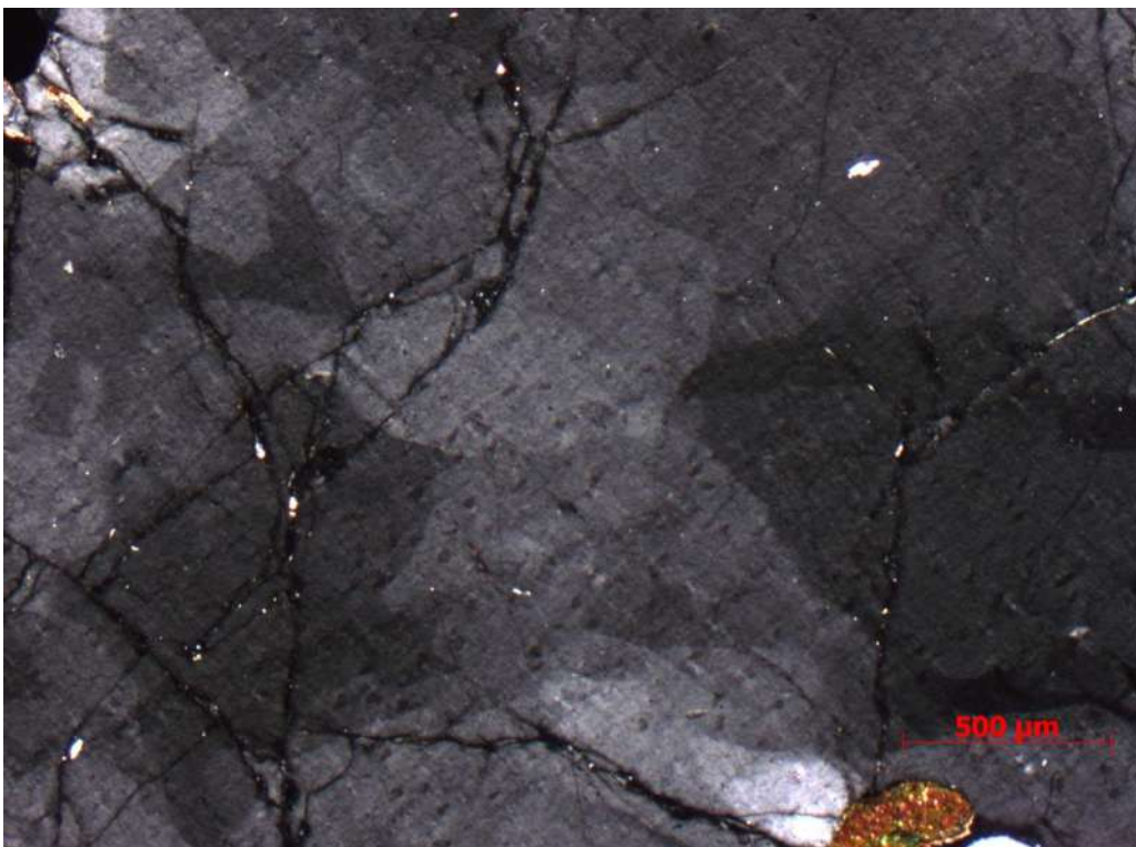
Figura 48 – Extinção ondulante em grande cristal de quartzo do granito megaporfírico (NX, aumento de 2,5X).
