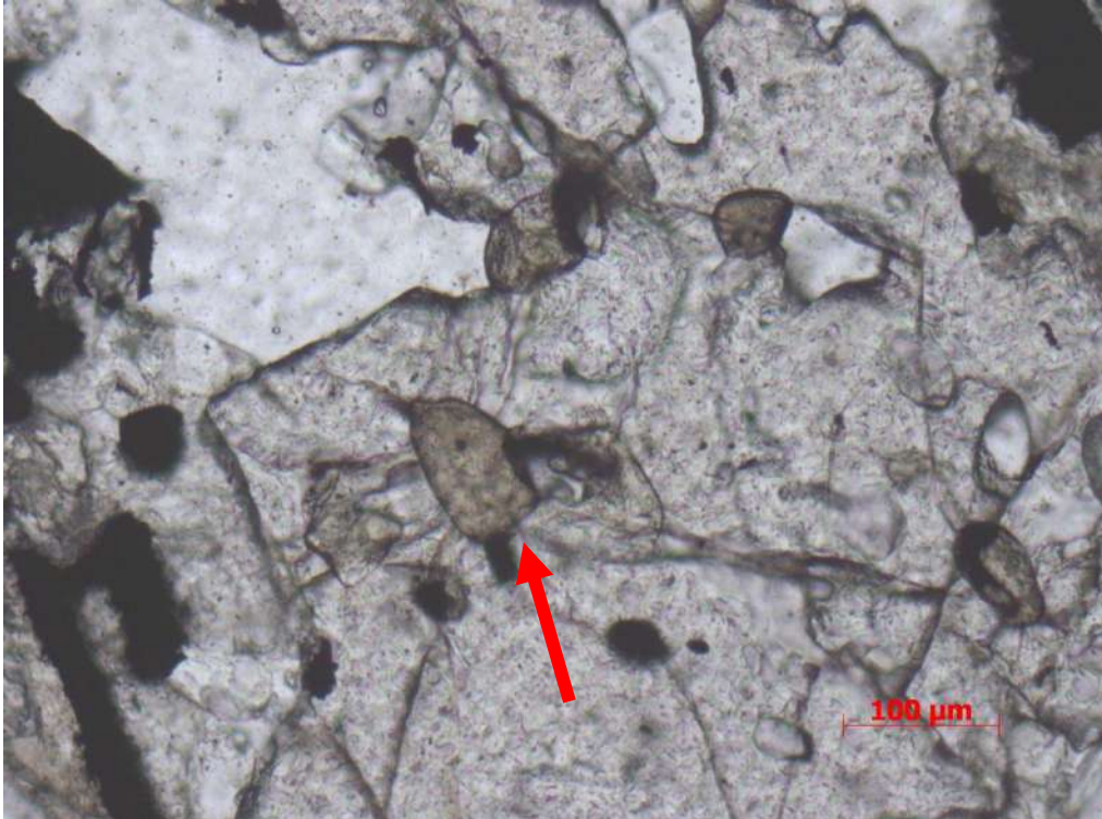
Figura 13 – Granada do biotita-gnaise migmatítico da Unidade São Fidelis fraturada, com bordas irregulares e inclusão de opacos e titanita, indicada pela seta vermelha (N//, aumento de 10X).
