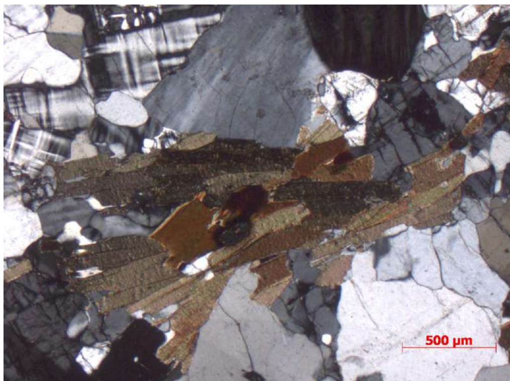
Figura 18 – Agregado de biotita com inclusão de zircão no granitóide foliado grosso (NX, aumento de 2,5X).
