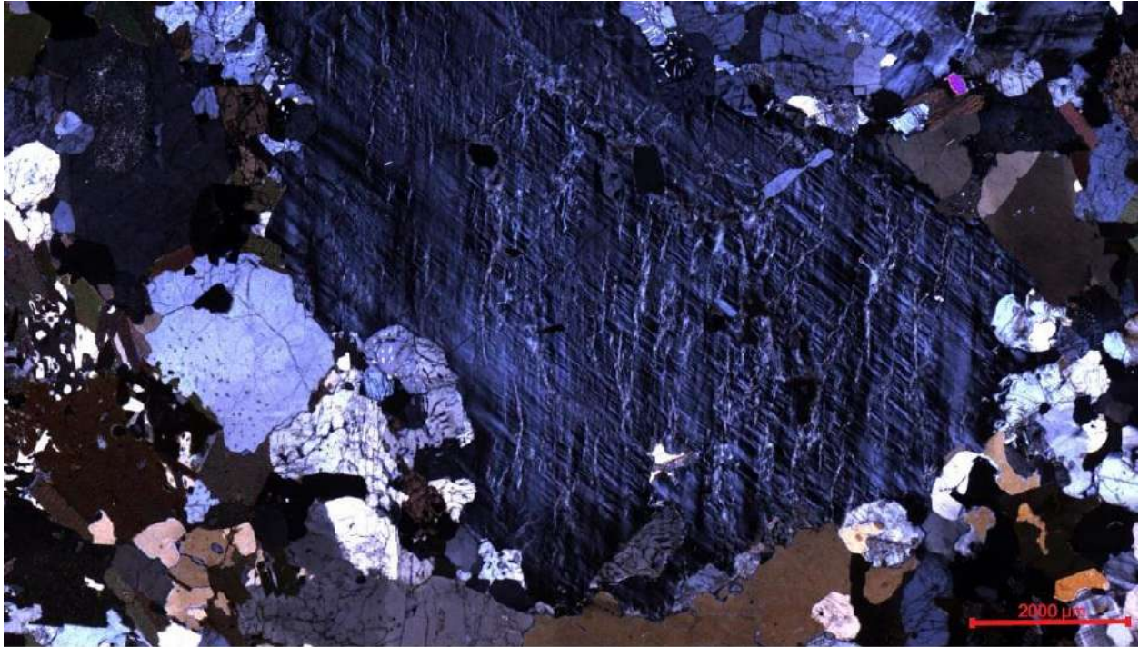
Figura 45 – Granito megaporfírico com textura porfírica evidenciada por fenocristais de microclina (NX, aumento de 2,5X).
