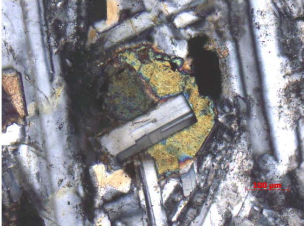
Figura 54 – Textura subofítica marcada pela inclusão parcial de grãos de plagioclásio em clinopiroxênio no diabásio da região (NX, aumento de 10X).
