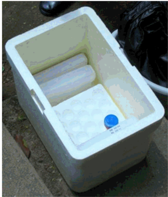
Figura 6 - Caixa de isopor refrigerada, para a preservação das amostras de água.
