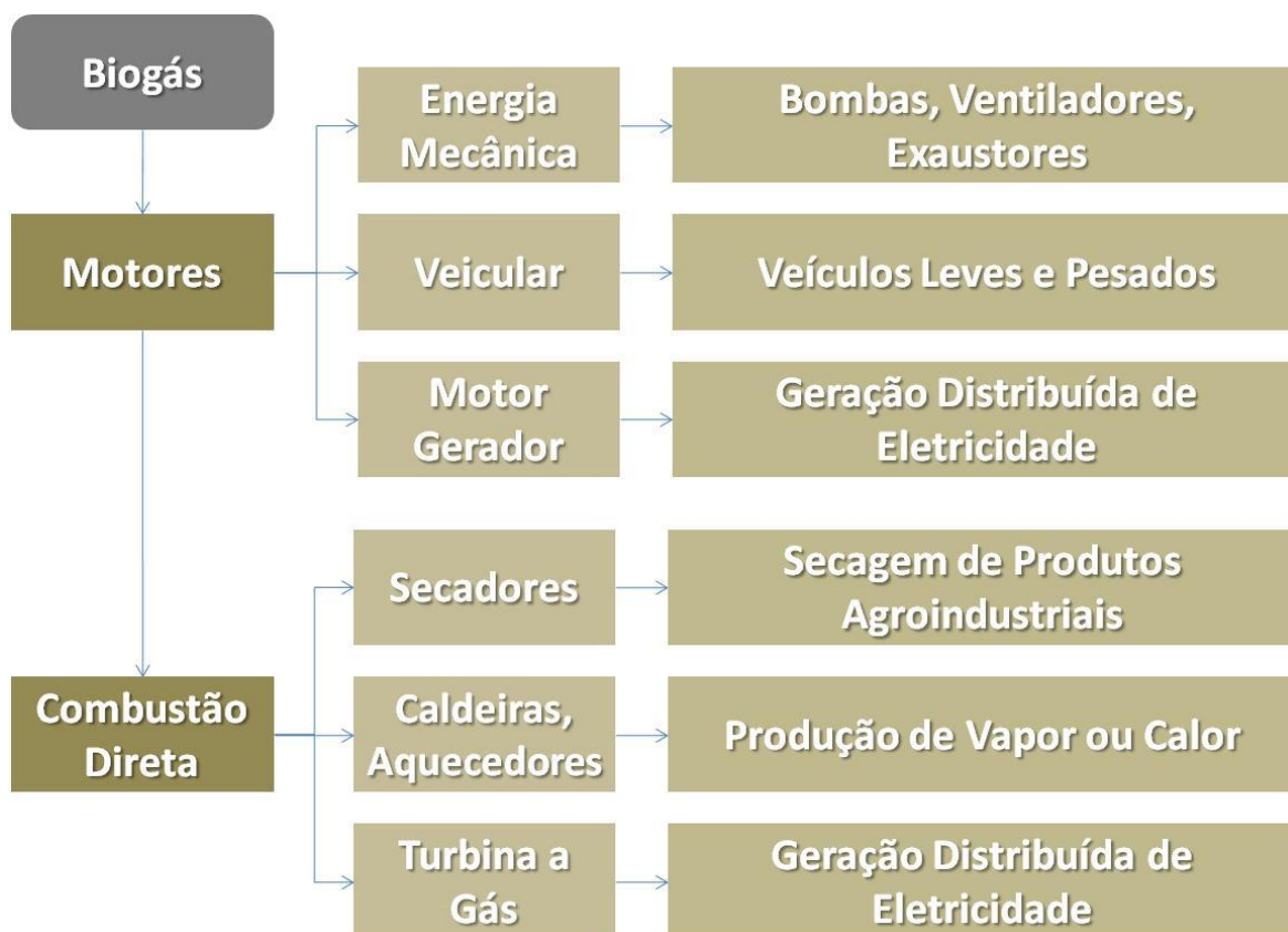
Figura 02 – Fluxograma resumido das possibilidades de utilização do biogás.
