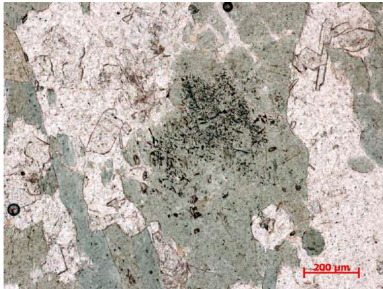
Figura 36 – Grão de hornblenda repleto de exsoluções de minerais opacos.
