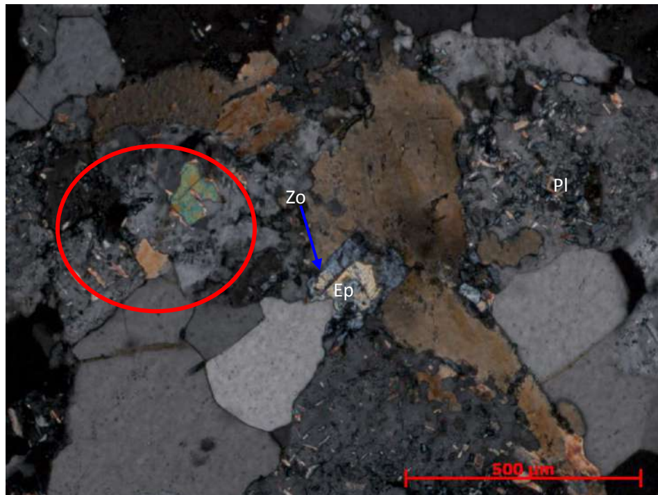
Figura 89 – Substituição parcial do plagioclásio (Pl) da fácies fina a média do granito Gentio por epidoto (ep), zoisita (Zo) e sericita. Destaca-se o crescimento de biotita sobre o plagioclásio (circulo vermelho).
