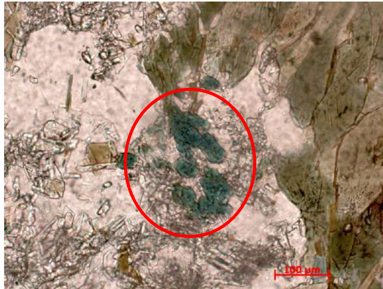
Figura 51 – Grão de ferro actinolita com pleocroísmo verde azulado crescendo junto com plagioclásio epidotizado e na borda da hornblenda.
