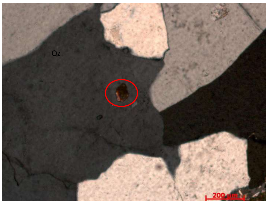
Figura 69 – Cristal de quartzo (Qz) com inclusão de zircão (indicado pelo círculo vermelho) no ortogneisse tonalítico Brejo Alegre.
