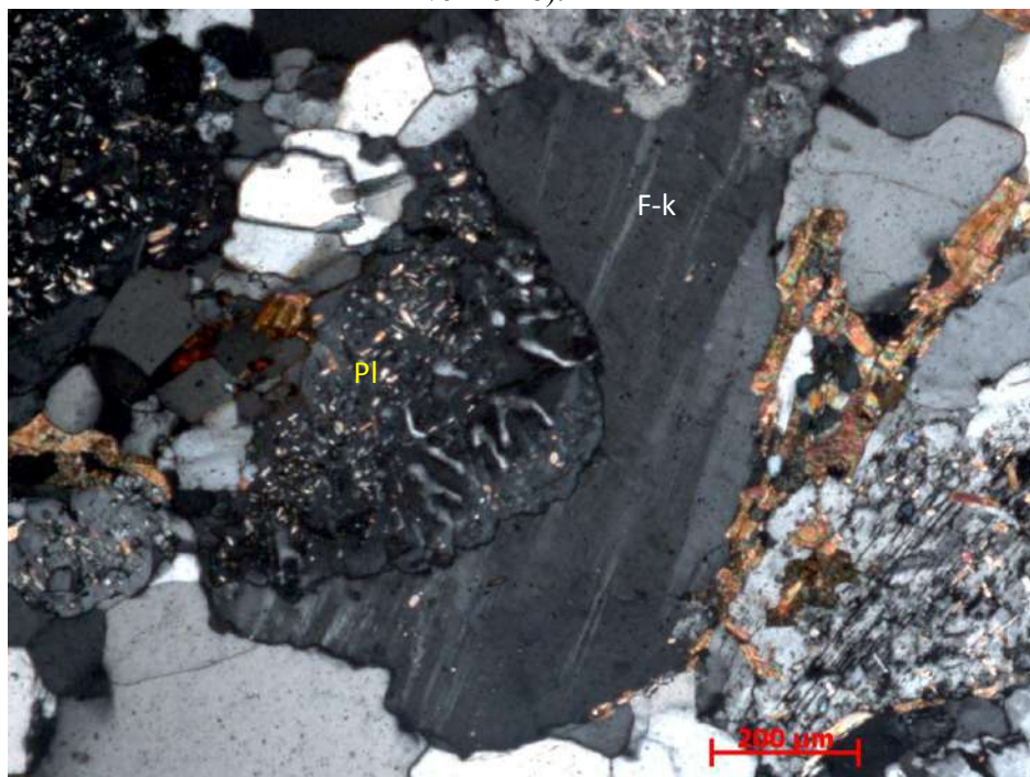
Figura 90 – Grão de plagioclásio (Pl) em contato com o feldspato potássico (F-k) onde se destaca a formação de intercrescimento mirmequítico. Rocha da fácies fina a média do granito Gentio.
