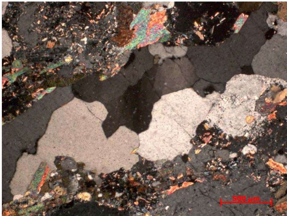
Figura 67 – Grão de quartzo do ortogneisse tonalítico Brejo Alegre mostrando extinção ondulante.
