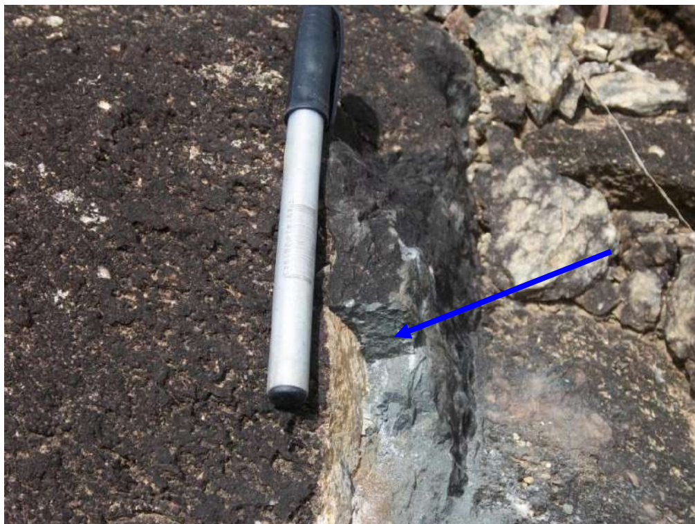
Figura 62 – Fratura no ortogneisse tonalítico Brejo Alegre preenchida por uma massa fina de coloração cinza clara representada por turmalina, quartzo, barita e albita.
