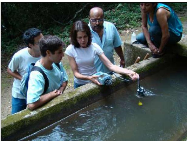
Figura 27 - Multisonda utilizada para medir *in situ* os parâmetros físico-químicos.
