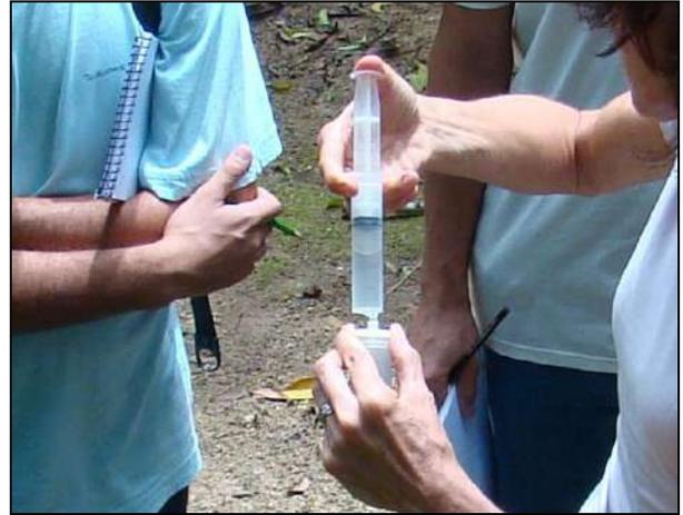
Figura 24 - Utilização da seringa e do filtro para coleta de água.
