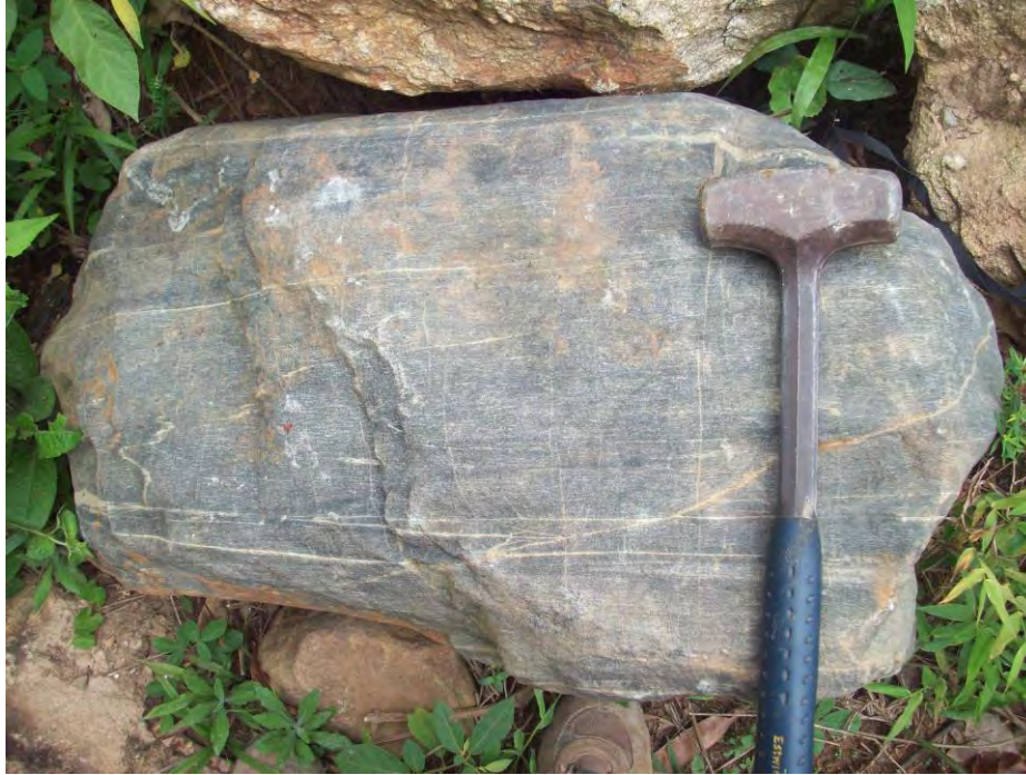
Figura 14 – Bloco de anfibólito com foliação marcada por níveis ricos em plagioclásio intercalados a níveis ricos em anfíbólios.
