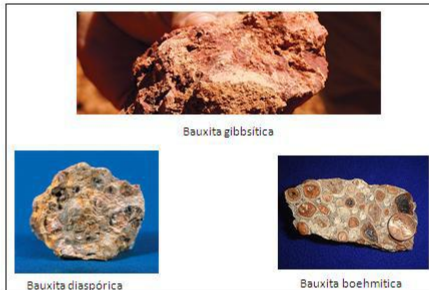
Figura 2 – Bauxita gibbsítica, diaspórica e boehmítica Fonte: Norsk Hydro, 2013
