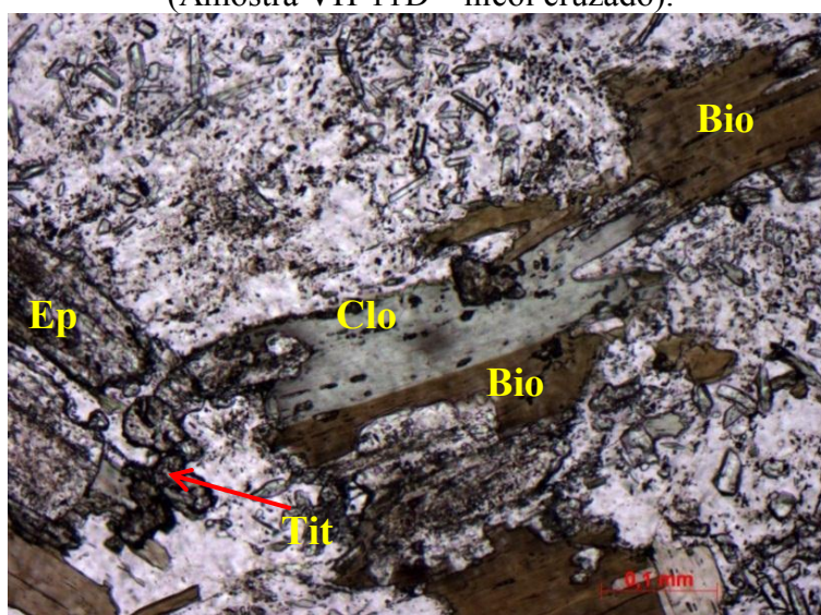
Figura 115 – Associação entre biotita (Bio), titanita (Tit), epidoto (Ep) e clorita (Clo), onde destaca-se que o grão de biotita está parcialmente substituído por clorita (Amostra VH-11D – nicól descruzado).
