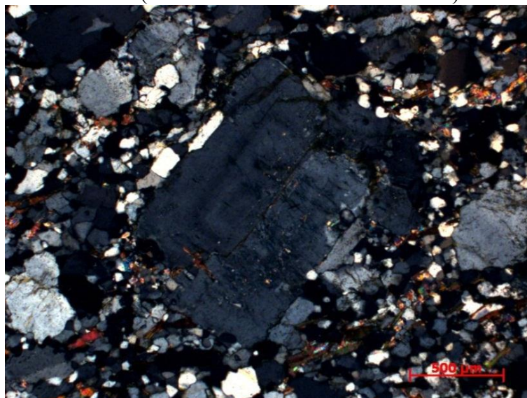
Figura 108 – Cristal de plagioclásio com zoneamento composicional concêntrico (Amostra VH-11I – nicól cruzado).
