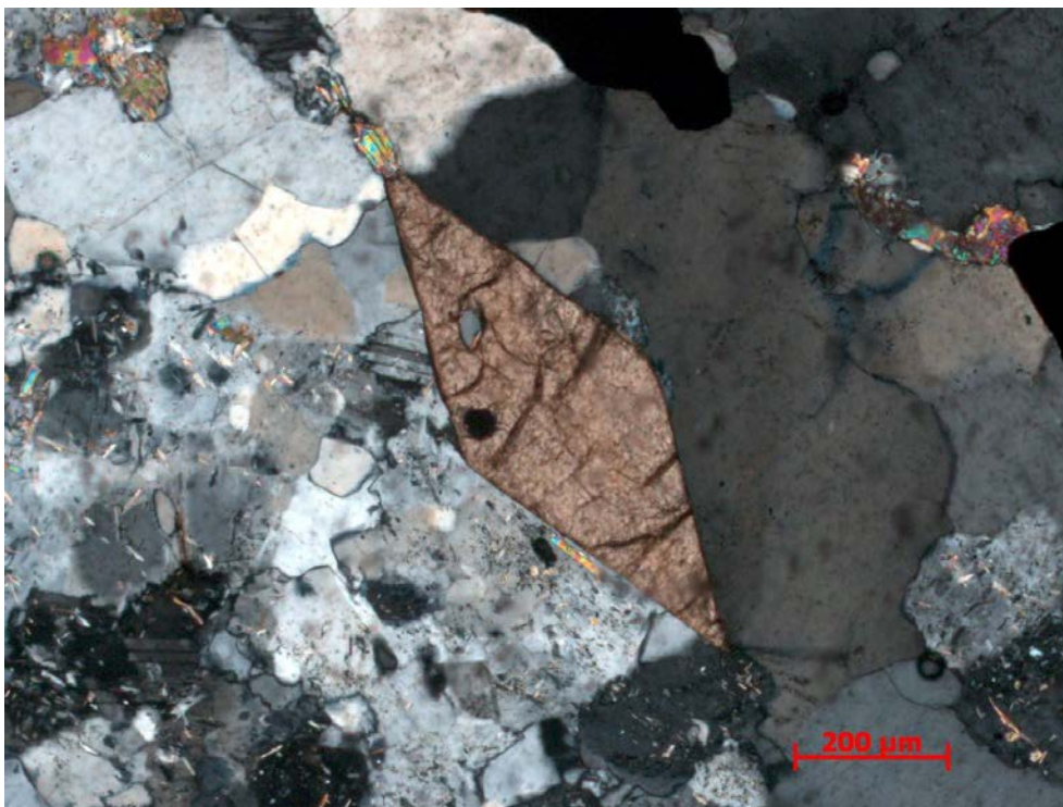
Figura 43 – Grão de titanita magmática (titanita 1 ) da fácies média/grossa com contornos idiomórficos e forma losangular. (Amostra RF-02 – nicól cruzado)
