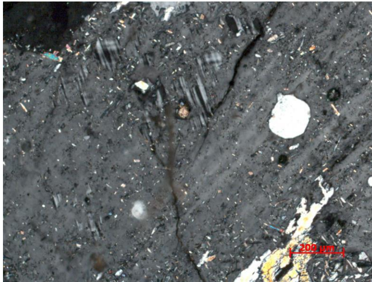
Figura 34 – Plagioclásio com crescimento de microclina. (Amostra RF-12 – nicól cruzado)
