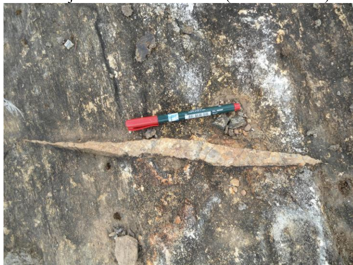
Figura 27 – Veio de quartzo originado por segregação metamórfica observada em afloramento da fácies fina/média do ortogneisse trondhjemítico Resende Costa (Ponto VH-53).
