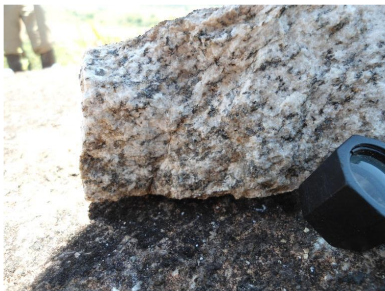
Figura 75 – Amostra do gnaiss granodiorítico evidenciando seus principais aspectos texturais (Ponto VH-91).
