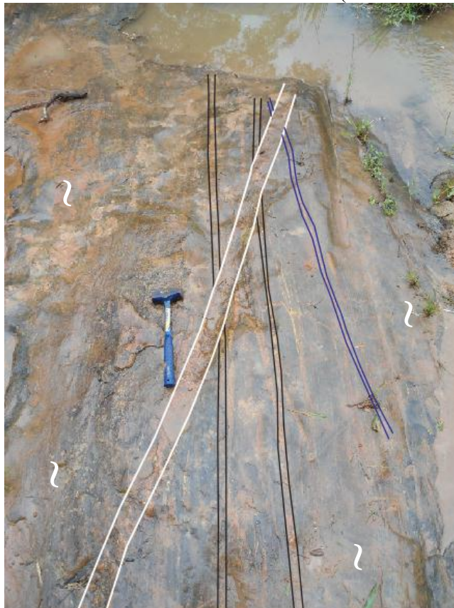
Figura 16 – Veios aplíticos quartzo feldspáticos concordantes (em preto) e discordante (em azul) à foliação do gnaise tonalítico Ramos. Presença de um dique granítico mais novo cortando todos os outros litótipos e a foliação do gnaise tonalítico Ramos (Ponto VH-75).
