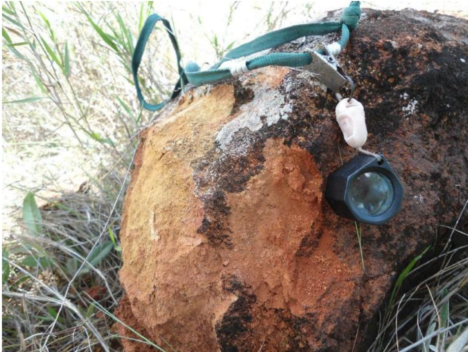
Figura 121 – Aspecto do diabásio alterado mostrando a impossibilidade de identificação de sua mineralogia (Ponto VH-124).
