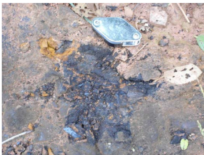
Figura 66 – Gondito em detalhe, onde se observa sua coloração preta devido a alteração da espessartita para pirolusita/psilomelana (Ponto VH-58).
