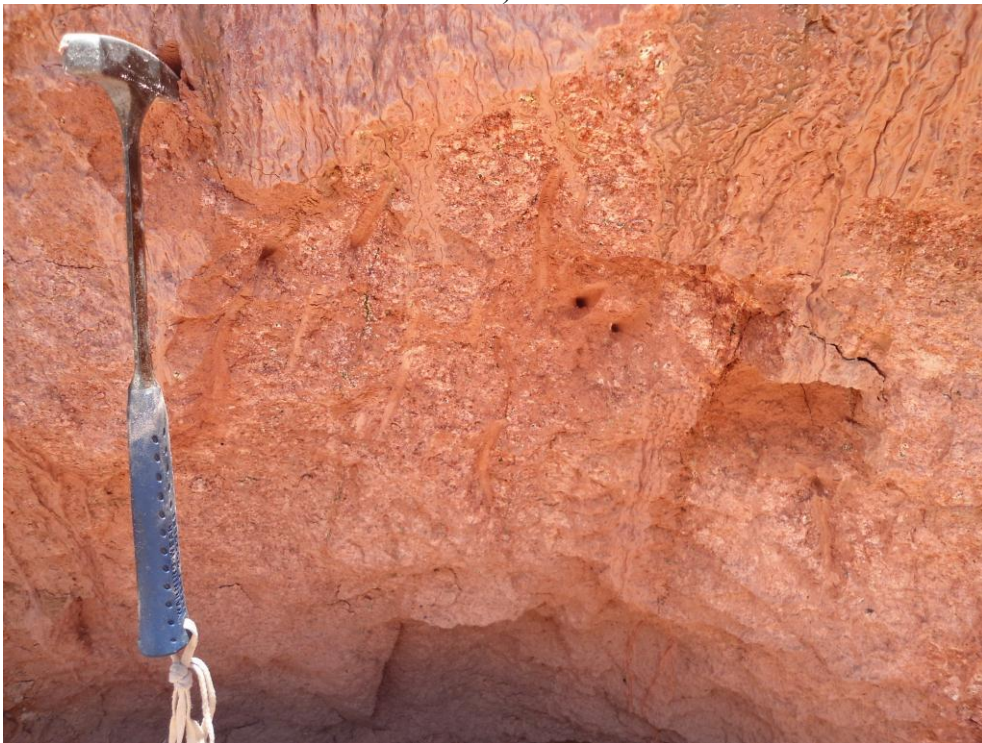
Figura 19 – Saprólito marrom avermelhado oriundo da alteração intempérica das rochas do ortogneisse trondhjemítico Resende Costa (Ponto VH-121).
