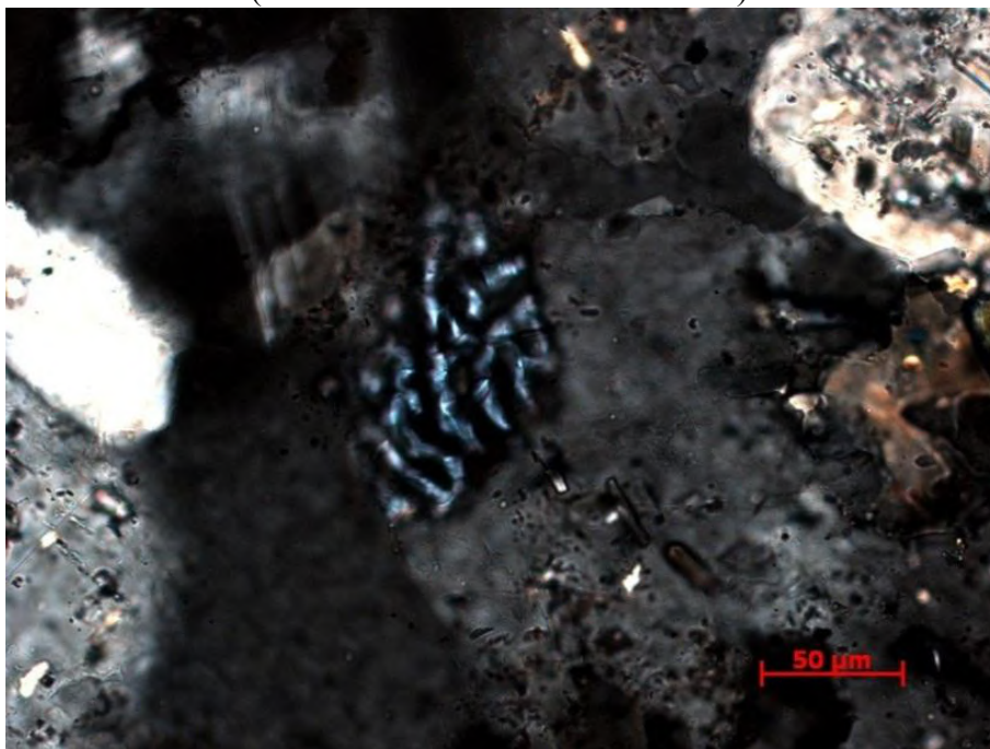
Figura 110 – Reação entre plagioclásio e microclina formando mirmequita (Amostra VH-11C – nicól cruzado).
