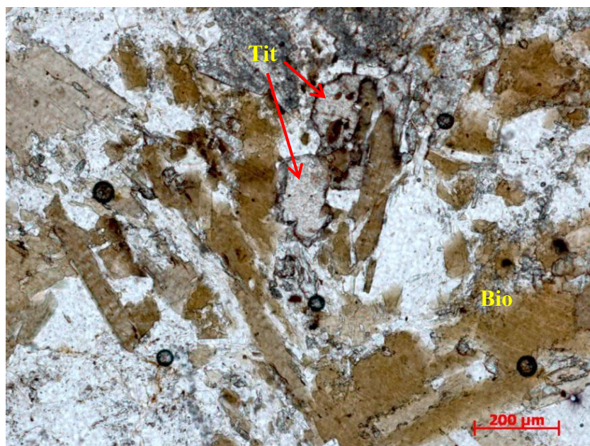
Figura 85 – Grãos de titanita (Tit) crescendo a partir da substituição de cristais xenoblásticos de biotita (Bio) (Amostra RF-45 – nicól descruzado).
