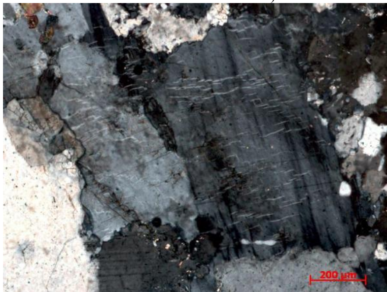
Figura 83 - Cristal de feldspato com intercrescimento perítico do tipo stringlet evidenciando suas duas direções de clivagem (Amostra RF-44A – nicól cruzado).
