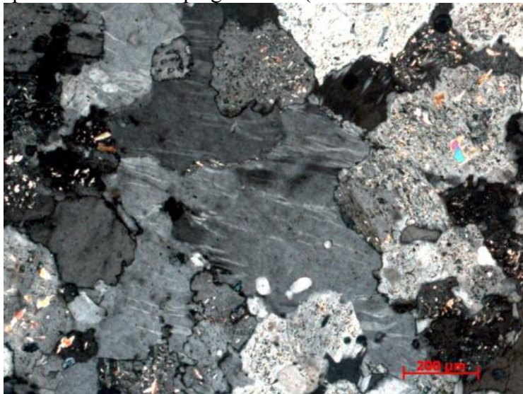
Figura 82 - Cristal de feldspato com intercrescimento perítico do tipo flame . (Amostra RF-46B – nicól cruzado).
