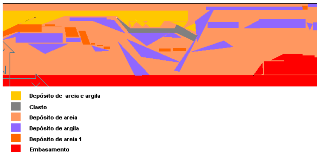
Figura 1: Modelo geoeletrico obtido a partir da seção geológica feita por Ramos (2002) e da foto mosaico do afloramento Rádio Agulhas Negras feita para essa monografia. Fonte: (Dias, et al., 2003).
