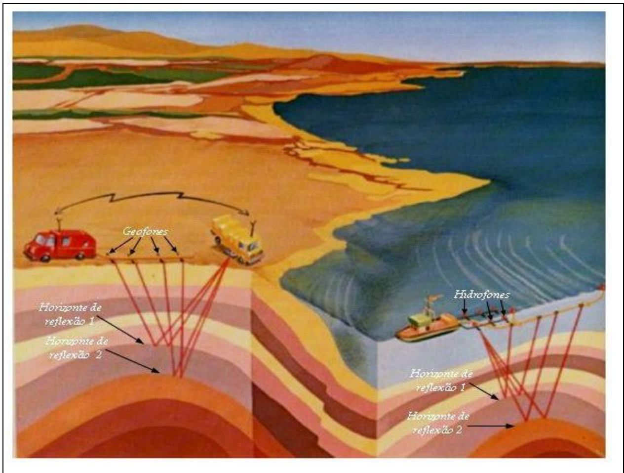
Figura 1.1a. Esquema de método sísmico de prospecção aplicado em terra e no mar (histpetroleo, 2009)
