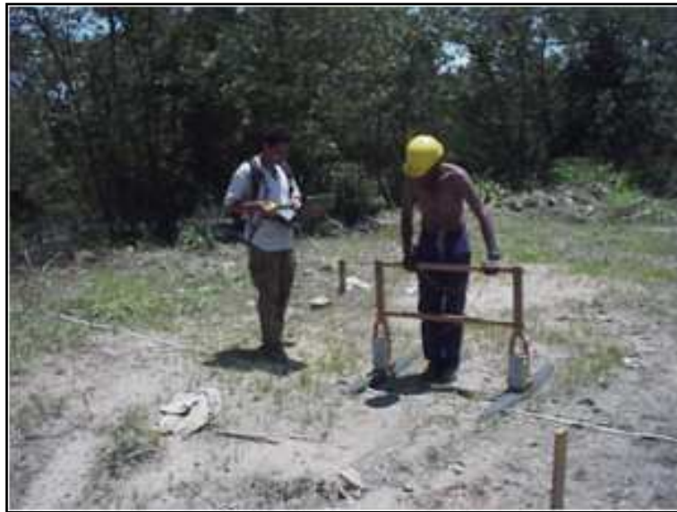
Figura 17 – Aquisição de dados GPR em campo.
