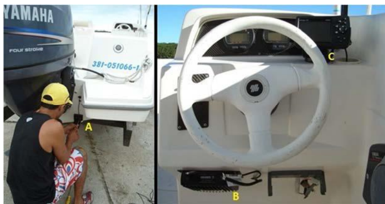
Figura 4 – Montagem dos equipamentos. A) Sensor da ecossonda; B) módulo da ecossonda e C) GPS
