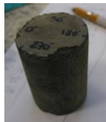
Figura 41 – Plugue horizontal de argilito (P32H) deformado na forma de elipsóide.
