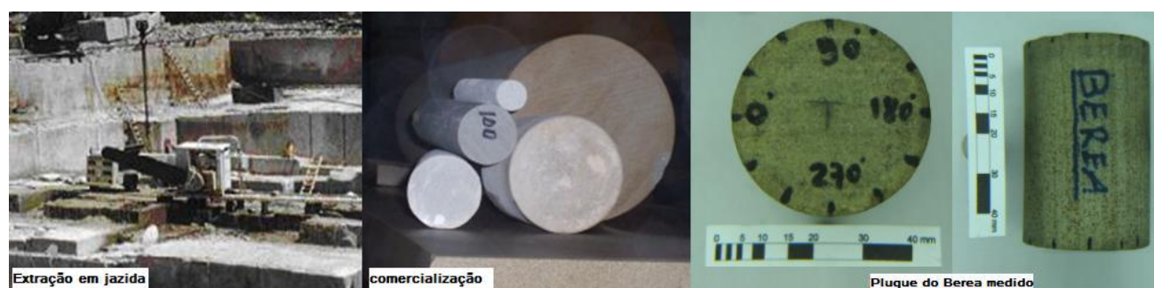
Figura 34 – Arenito Berea desde a extração ao plugue referência para testes no laboratório de Física de Rochas do CENPES.
