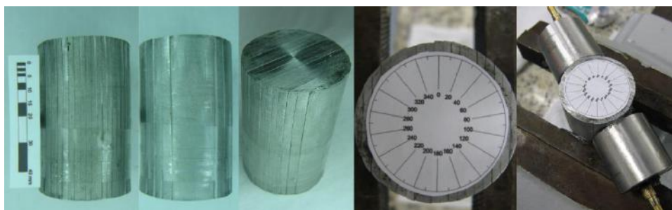
Figura 05 – Plugue de 1,5” em alumínio fatiado (espessura de 2,0 mm das placas) feito com usinagem de precisão (laser) conforme 3º modelo de Vernik. Nas imagens acima, o plugue montado a partir das placas e visto de diferentes ângulos.
