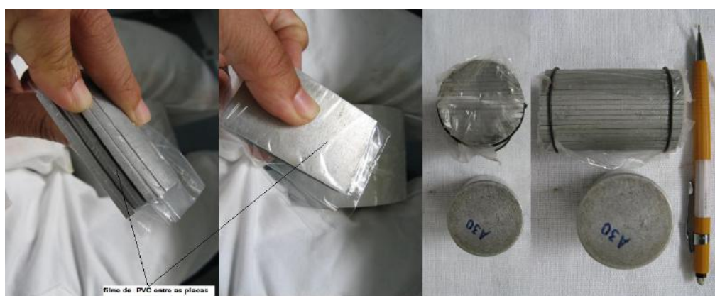
Figura 24 – Acima as fotos mostram a colocação do filme de PVC entre as placas do plugue de alumínio.
