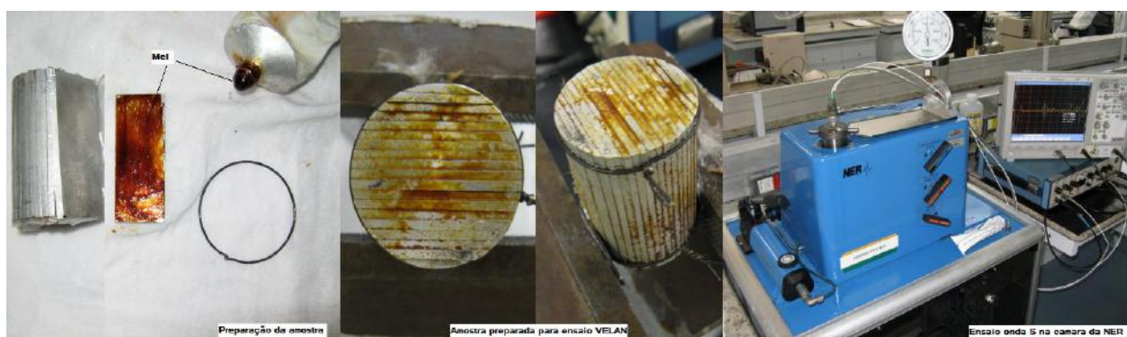
Figura 30 – Acima as fotos mostram a colocação do mel entre as placas do plugue de alumínio; a preparação para ensaios de anisotropia da onda P no Sistema Velan e o confinamento da amostra de alumínio para as medidas de anisotropia radial das ondas S1 no sistema NER.
