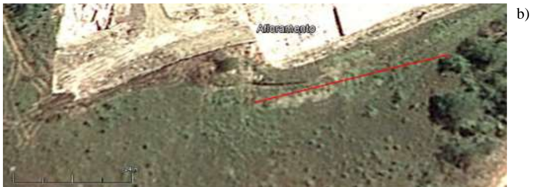
Figura 04 - a) Mapa de localização da Pedreira Pedra Branca com vias de acesso e a área a ser estudada. b) Imagem do afloramento com a linha de aquisição em vermelho com azimute de 247 graus e comprimento de 67 metros. Fonte Google Earth (2009).
