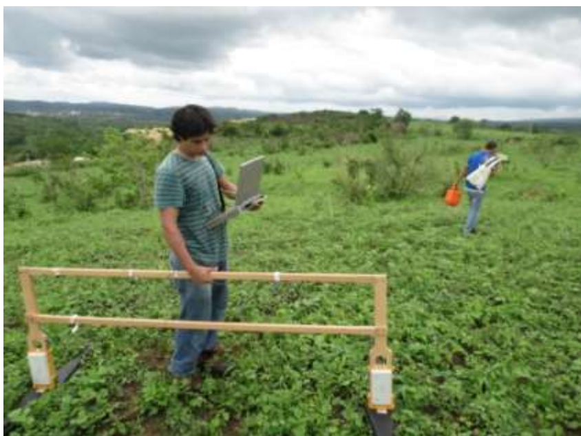
Figura 08 - Aquisição dos dados GPR com equipamento RAMAC em cima do afloramento.
