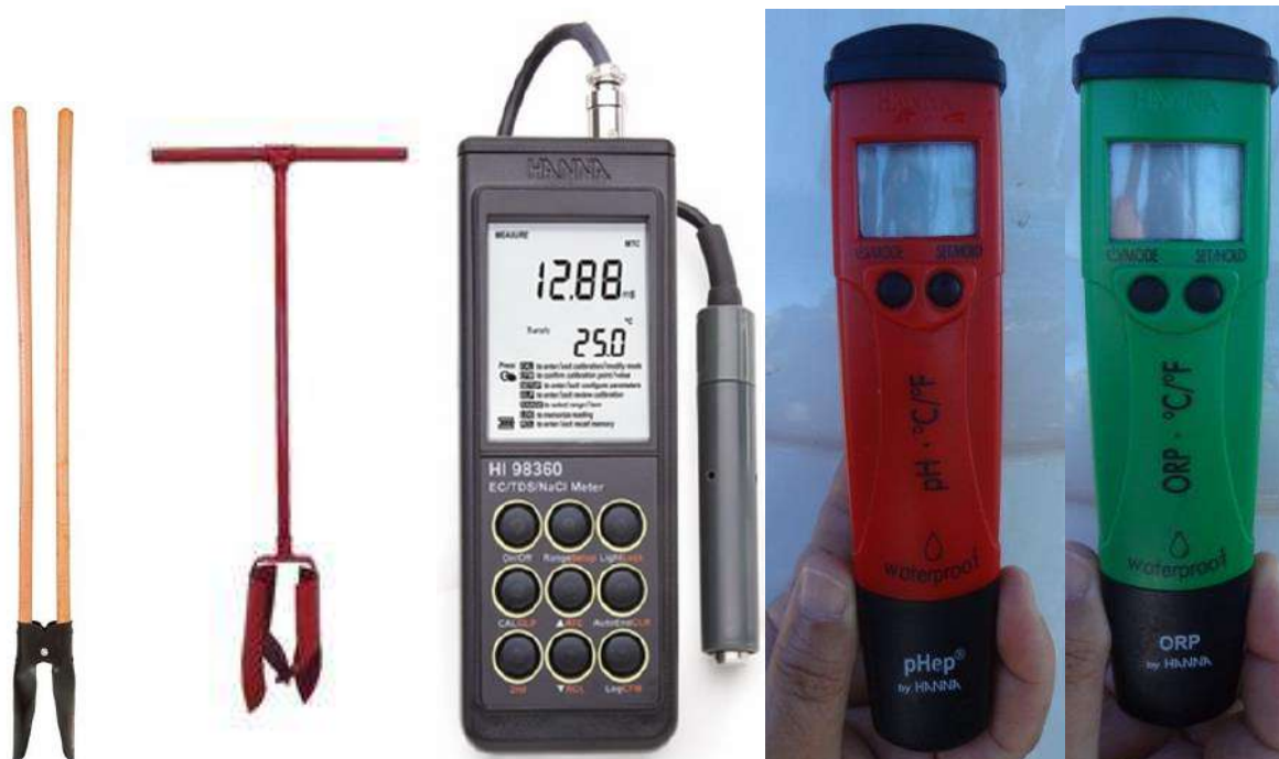
Figura 16: Da esquerda para direita: cavadeira, trado manual e os aparelhos portáteis usados nas medições de campo.
