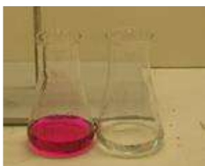
Figura 1: Titulação com fenolftaleína: (a) antes da titulação, (b) após viragem de cor.
