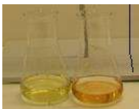
Figura 2: Titulação com alaranjado de metila: (a) antes da titulação, (b) após viragem de cor.
