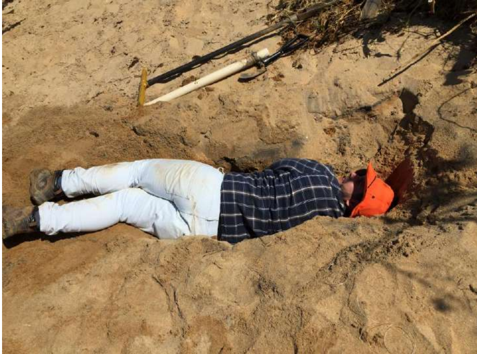
Figura 17: Coleta de água subterrânea após a abertura do furo com a cavadeira e trado manual.
