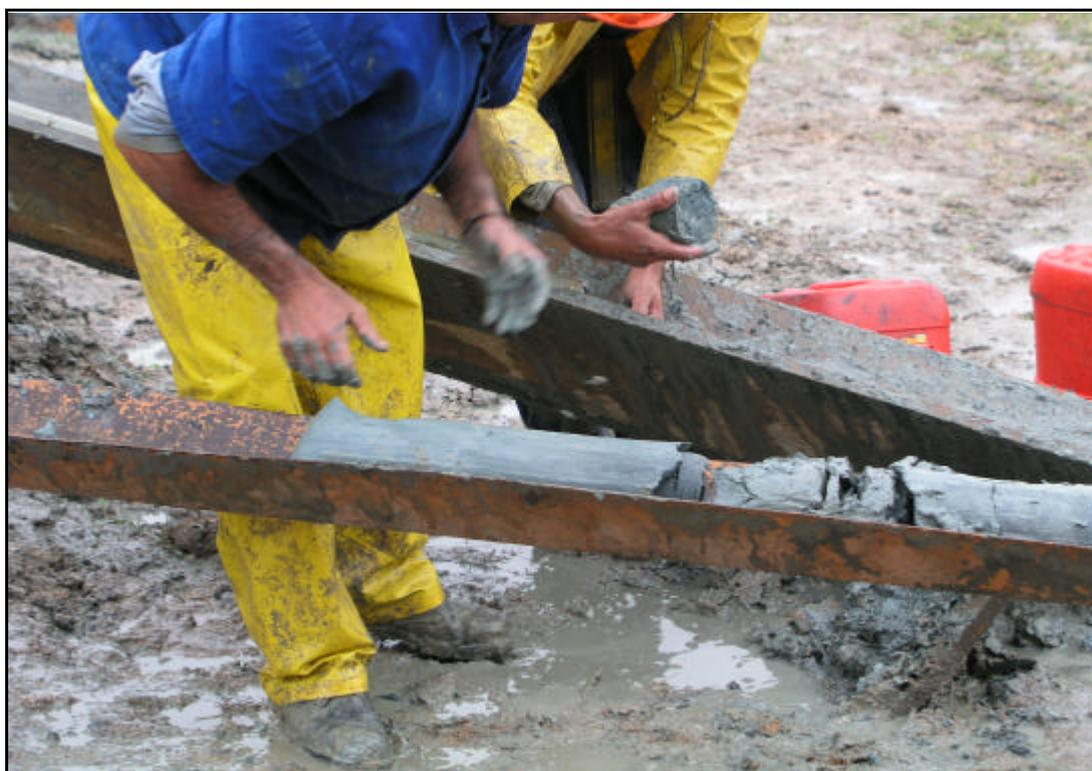
Figura 10: Extrusão do testemunho
