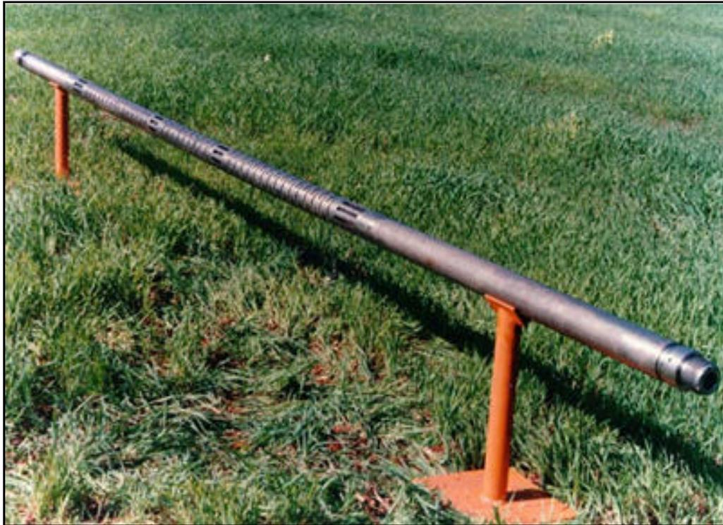
Figura 18: Ferramenta Sônica (HYDRO – LOG)
