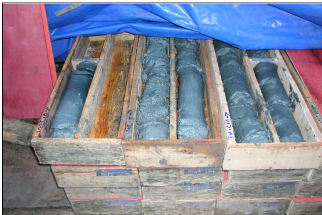
Figura 11: Testemunhos acondicionados em caixas duplas de 1 m de comprimento com placas metálicas de identificação.
