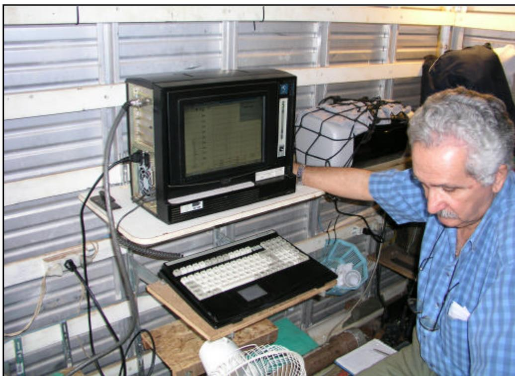
Figura 15: Operação de perfilagem com registro digital e acompanhamento 'real time' no monitor
