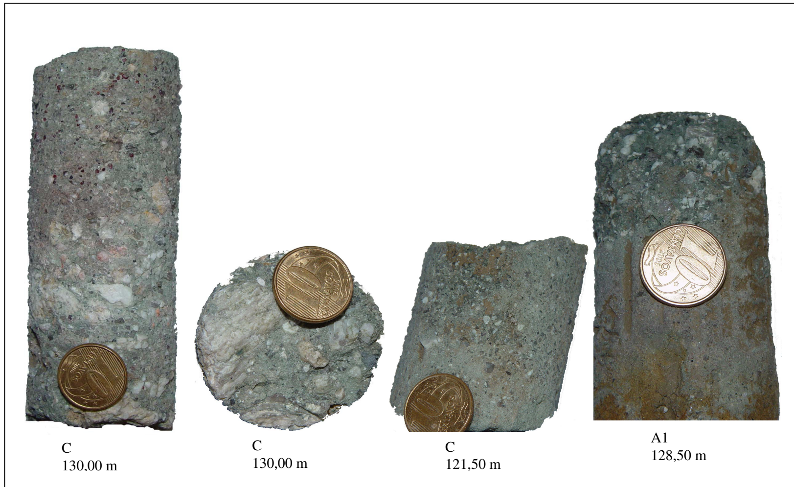
Figura 5 – Litofácies sedimentares identificadas; C – conglomerado, clasto suportado, mal selecionado, com grânulos de quartzo, feldspato e granada, cor cinza.; A1 - arenito médio, mal selecionado, alta argilosidade; cor cinza.
