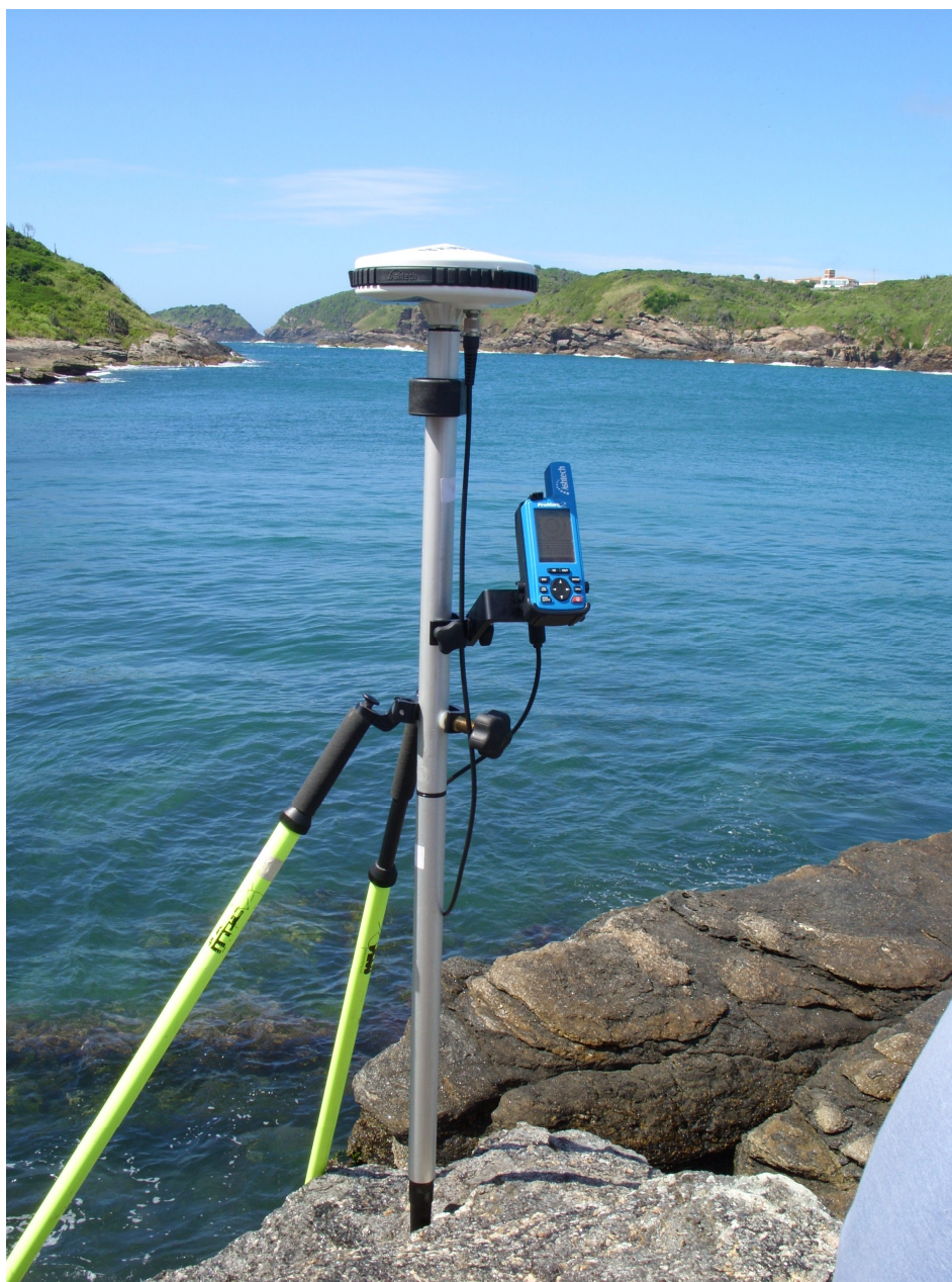
Figura 11. Coleta de dados GPS na Praia do Forno – Município de Armação dos Búzios. O bastão está localizado exatamente sobre a incrustação do vermetídeo “fóssil”, na reentrância das rochas.
