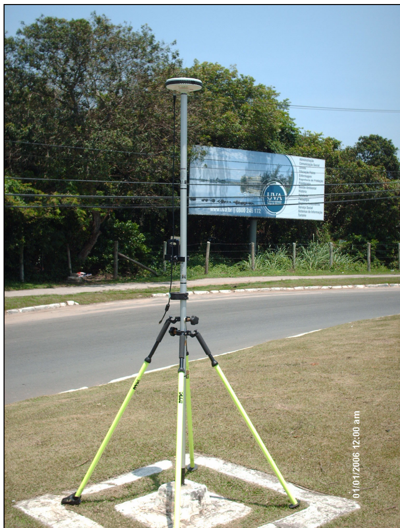
Figura 10. Estação base GPS na Referência de Nível 3073D do IBGE.
