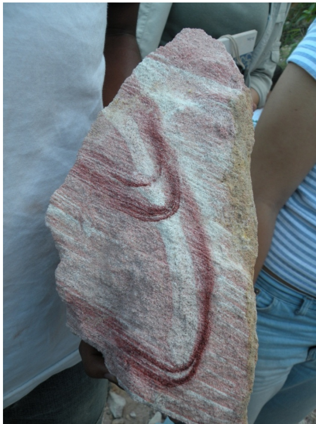
Fotografia 4: Amostra de mão de um arenito laminado com percolação de óxido de ferro e cimento de caulinita. BR-122 (Rodovia Asa Branca), município de Exu – PE.
