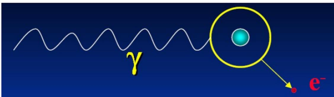
Figura 03 – Efeito foto-elétrico. . (Modificado de Baker Hughes INTEQ, 2004).
