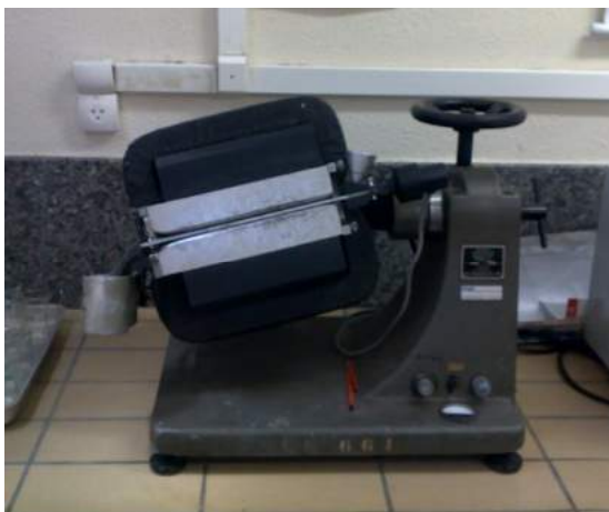
Figura 3 - Separador eletromagnético Frantz, do Laboratório de Sedimentologia Analítica do Departamento de Geologia/UFRJ.
