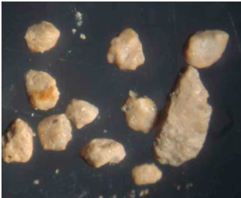
Figura 22 - Monazita terrosa de cor bege, brilho resinoso e superfície áspera. Os grãos apresentam-se na forma de fragmentos, variando entre esféricos e pouco esféricos e de angulosos a subangulosos.
