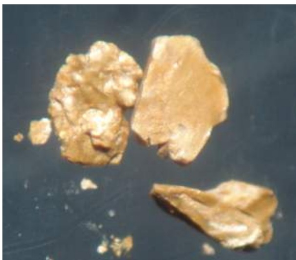
Figura 19 - Hidrobiotita de cor dourada, brilho ceroso e hábito micáceo. Suas formas apresentam certo desgaste mecânico, pois não é possível observar a forma hexagonal típica da biotita/hidrobiotita.
