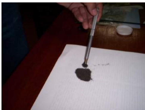
Figura 2 - Uso de imã de mão para a retirada de minerais ferromagnéticos (ex. magnetita).
