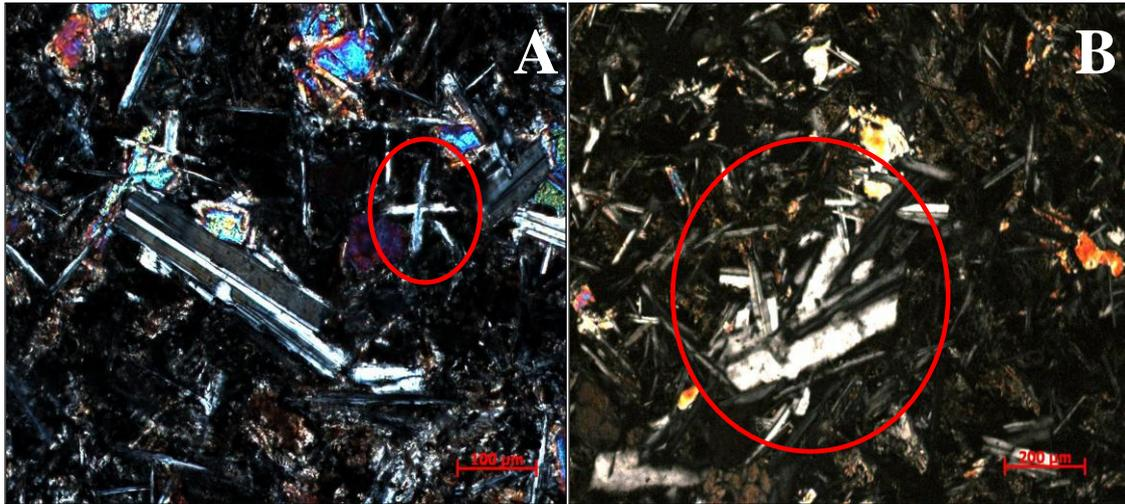
**Figura 45.** Plagioclásio exibindo geminação polissintética. Destaque para a estrutura em roseta em A, crescimento de micrólitos de plagioclásio nucleados a partir de um ponto central único, e para a textura glomeroporfirítica em B, aglomerado de fenocristais de plagioclásio.
