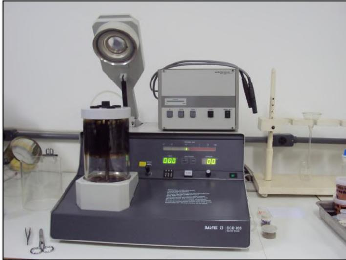
**Figura 29.** Semi metalizador Sprenger Coater BAL-TEC SCD 005
