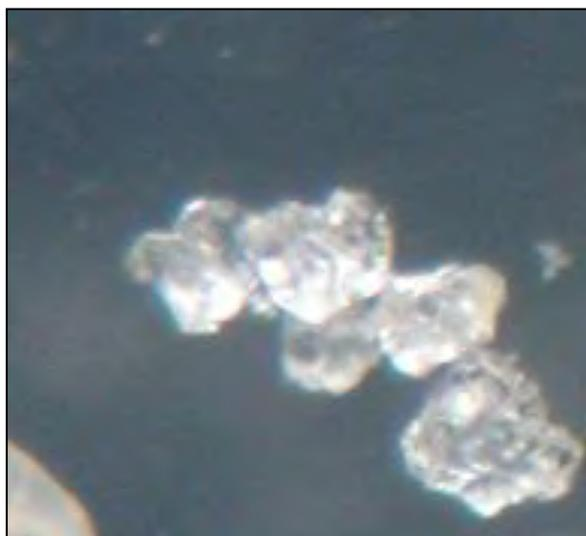
**Figura 72.** Grãos de quartzo encontrados após a separação densimétrica.
