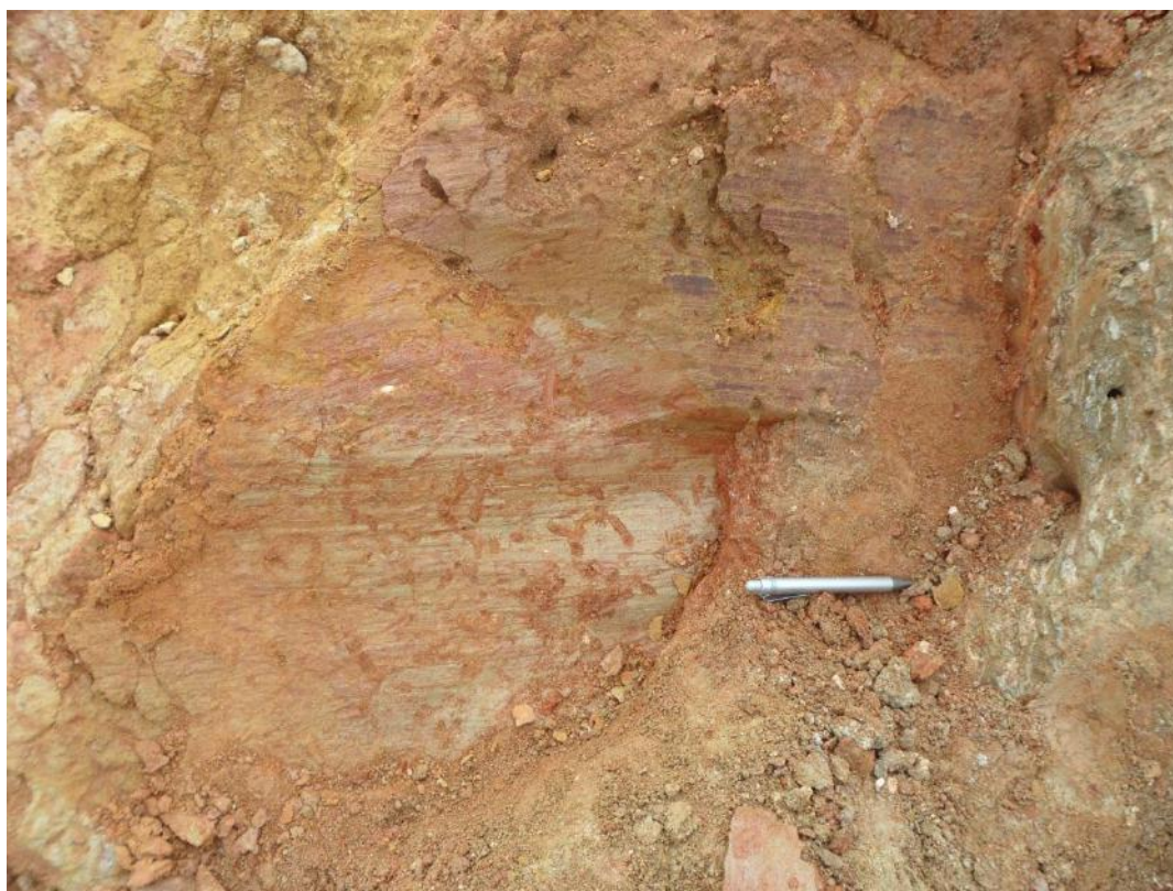
Figura 15: Ponto EVR-06 – Plano de falha sinistral com estrias fortemente direcionais e bioturbações posteriores a este, e bem preservadas.
