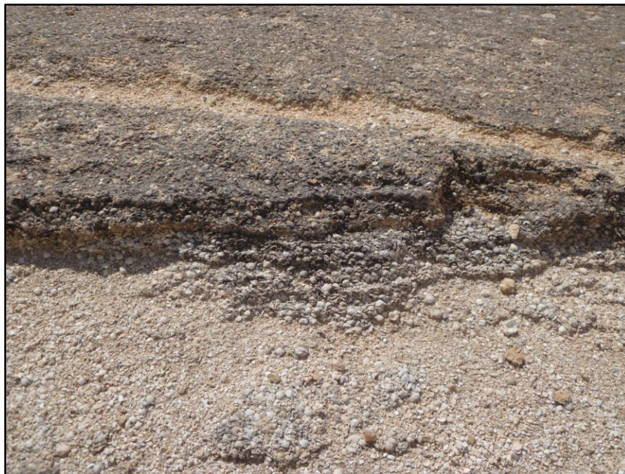
Figura 7 – Antiga extração artesanal de calcário em Shark Bay, costa Oeste da Austrália. As coquinas são compostas por bioclastos pouco a muito fragmentados, estão cimentadas (cimento aragonítico) e apresentam estratificação cruzada de ângulo baixo. (Foto: Daniel Thompson).
