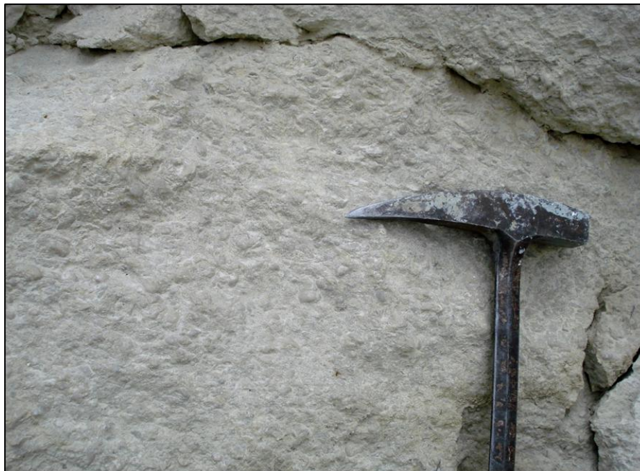
Figura 44 – Fácies cRx. Calcirrudito bioclástico clasto-suportado, moderadamente selecionado, apresentando estratificação cruzada de porte médio.
