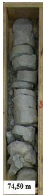
Figura 18: A descrição de testemunhos comprova que se trata de um pacote de folhelho, como mencionado anteriormente. É um argilito síltico, rico em detritos vegetais e fragmento de lenho, com Vsh = 80%
