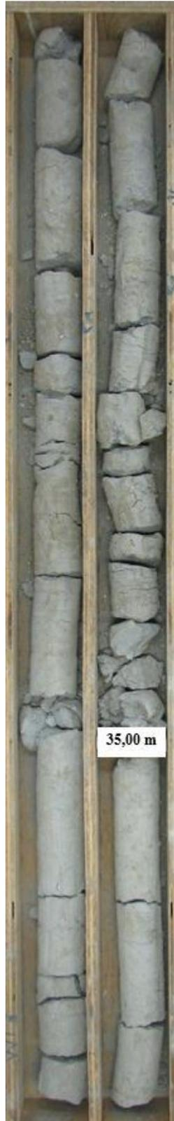
Figura 15: A descrição de testemunhos comprova que se trata de arenitos fino, angulosos com presença de conchas do tamanho grânulo a seixo, confirmando o fato do GR e SP baixos e das curvas Res(16N) e Res(64N) separadas.
